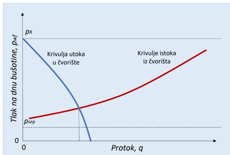
**Slika 3-3.** Proizvodni kapacitet sustava ograničen karakteristikama utoka (Čikeš, 2015)
