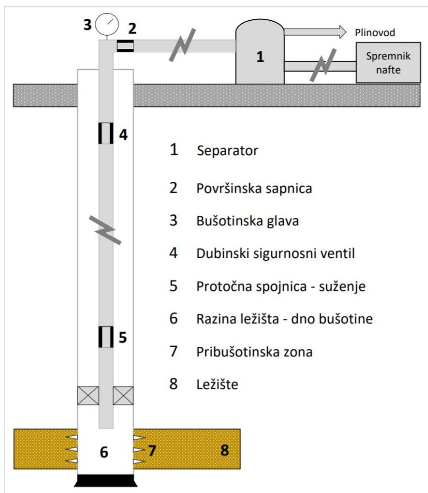
Slika 2-1. Smještaj najčešće korištenih čvorišta proizvodnog sustava (Čikeš, 2015)
