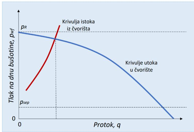
**Slika 3-2.** Proizvodni kapacitet sustava ograničen karakteristikama istoka (Čikeš, 2015)
