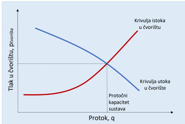
**Slika 2-2.** Određivanje protočnog kapaciteta sustava (Čikeš, 2015)
