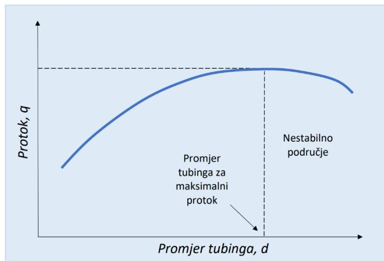
**Slika 3-5.** Određivanje optimalnog promjera tubinga (Čikeš, 2015)
