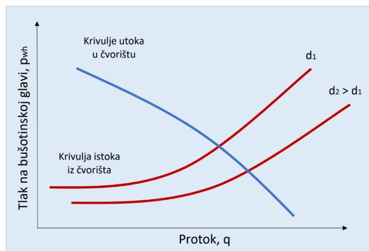
**Slika 2-4.** Učinak promjene unutarnjeg promjera cjevovoda (Čikeš, 2015)
