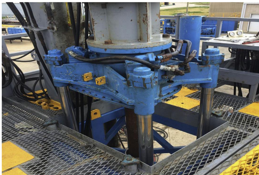
Slika 3-12. Prikaz hidrauličkog vrtaćeg stola (Skinner, 2019)
