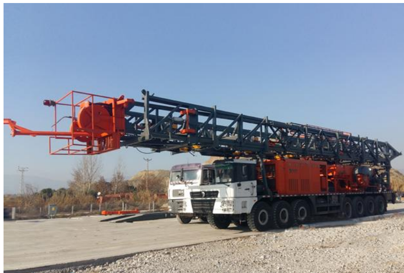
Slika 2-4. Pokretno kopno bušaće postrojenje sa teleskopskim tornjem ( https://www.jereh-e.com , 2020)
