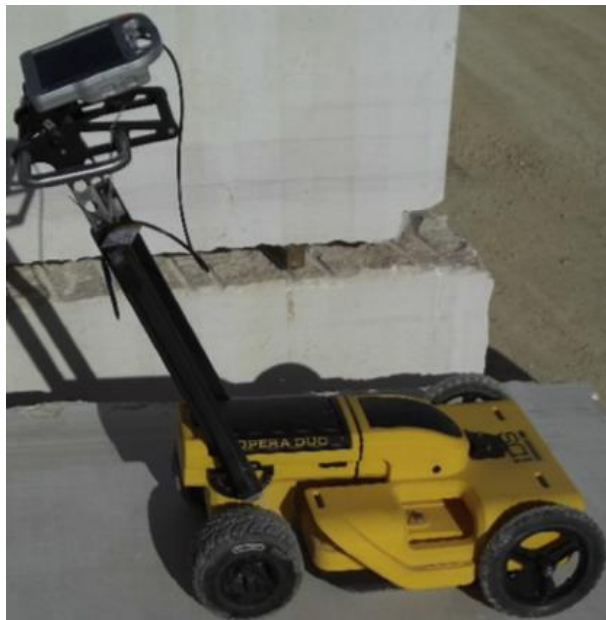
Slika 3-3 GPR uređaj (Elkarmoty i dr., 2008)
