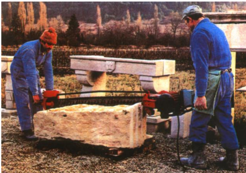
Slika 5-2 Ručna lančana sjekačica (Dunda i Kujundžić, 2003)
