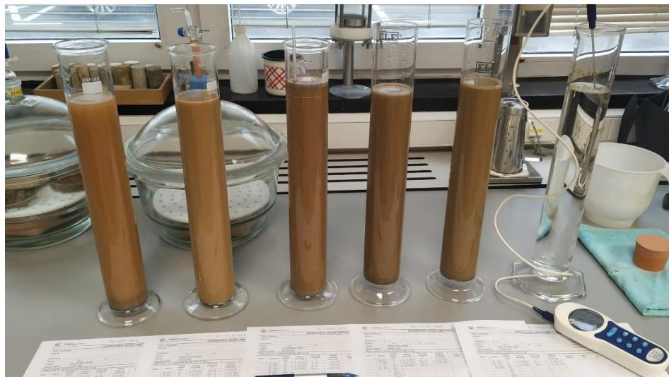
Slika 3.3 Ispitivanje u tijeku: menzure s ispitnim uzorcima, kontrolna menzura, termometar (foto: Gavrić)
