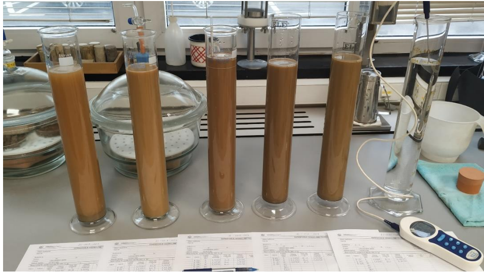
Slika 3.3 Ispitivanje u tijeku: menzure s ispitnim uzorcima, kontrolna menzura, termometar (foto: Gavrić)
