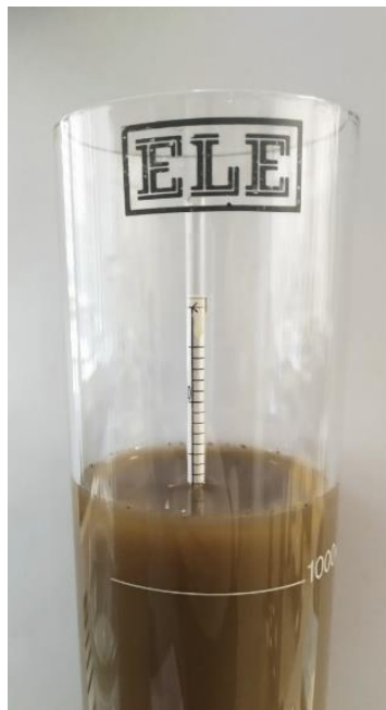
Slika 3.4 Očitavanje gustoće na areometru (foto: Gavrić)
