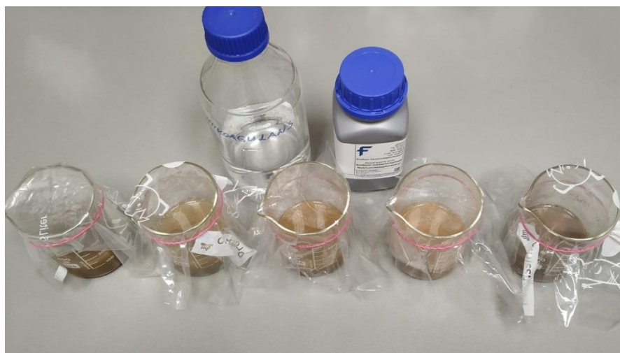
Slika 3.2 Ispitni uzorci s dodanom otopinom antikoagulansa (foto: Gavrić)
