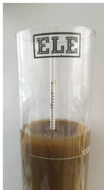
Slika 3.4 Očitavanje gustoće na areometru (foto: Gavrić)
