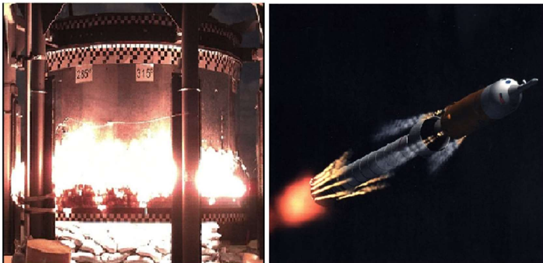
Slika 4-13. Upotreba linijskog kumulativnog rezača pri razdvajanju donjeg dijela rakete (NASA, 2021)
