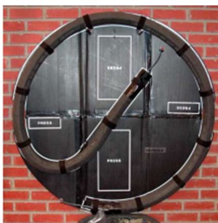
Slika 4-12. Kumulativni rezač za probijanje otvora u zidu (Bohanek, 2013)
