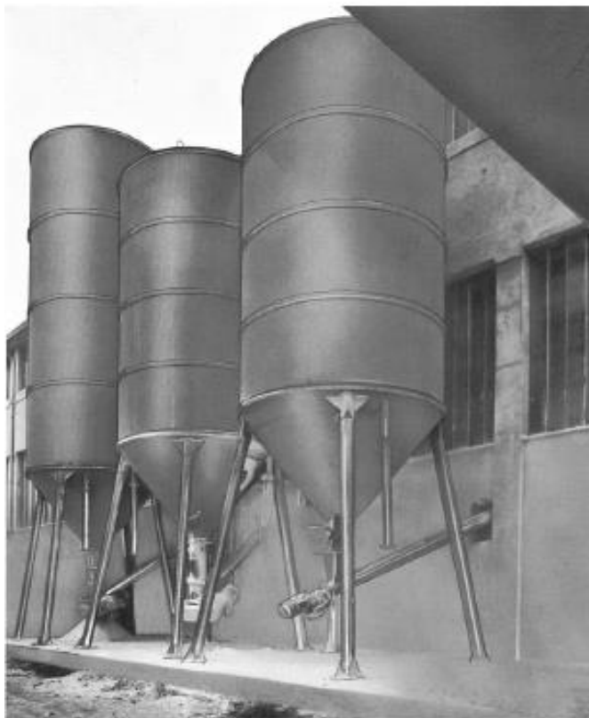
Slika 4-1. Silosi iz kojih se suhe frakcije dodaju u miješalicu (Dunda i Kujundžić, 2003)
