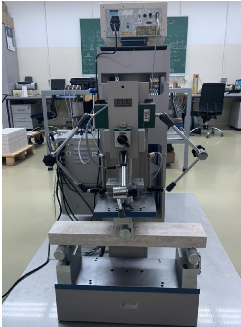
Slika 4-5 Prikaz postavljanja uzorka treće serije
