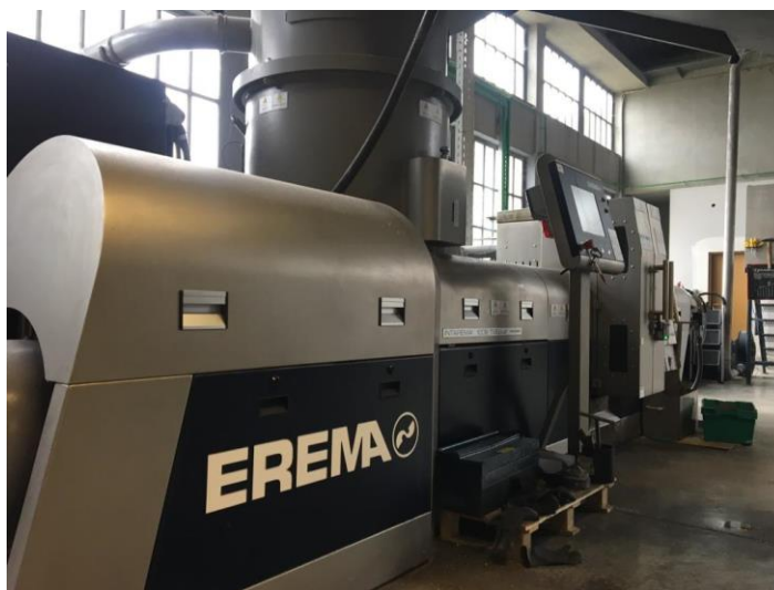
Slika 2-4. Stroj za granuliranje tvrtke Erema (Pos-plast, 2021)
