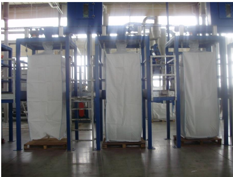
Slika 3-11. Pakiranje mljevenih prozirnih i šarenih PET listića u velike vreće (Ptiček Siročić i sur., 2016)
