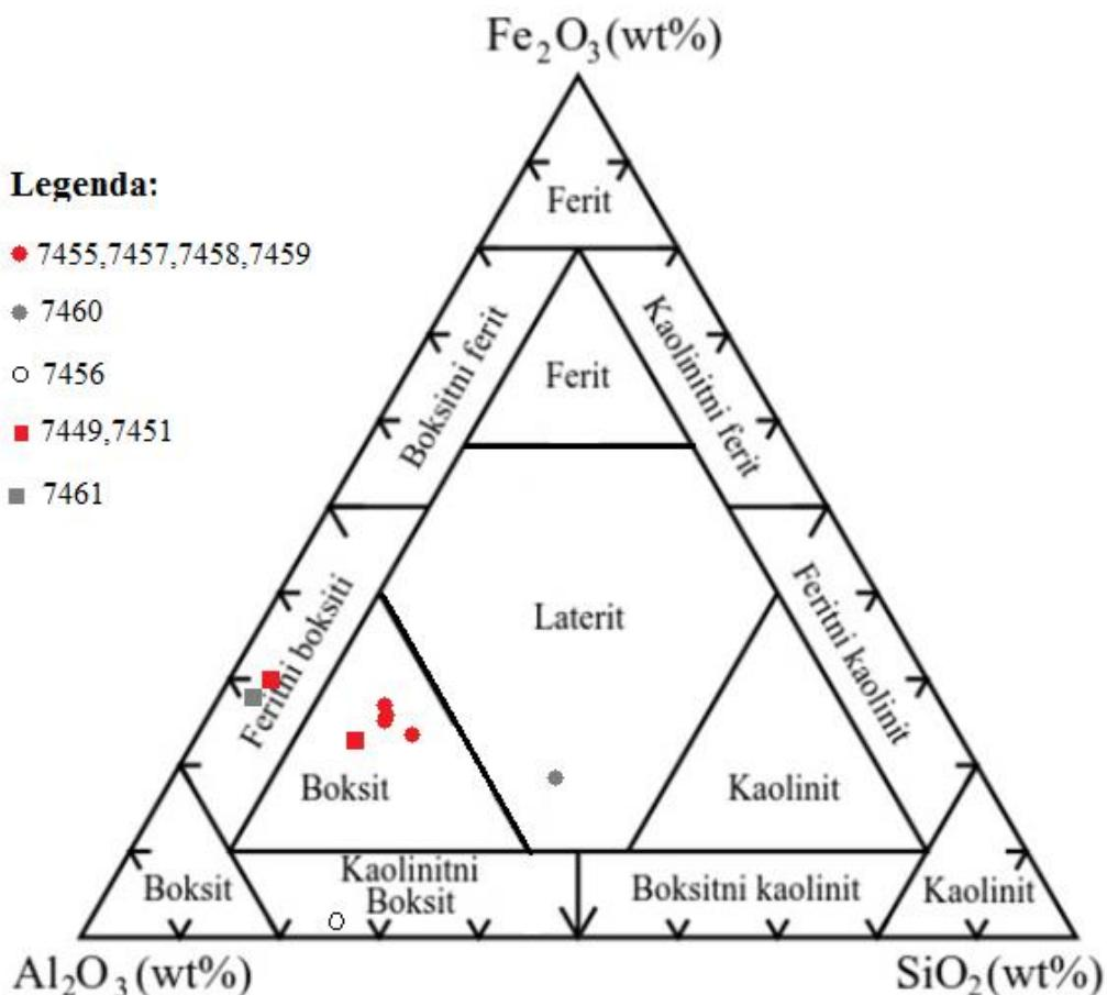
Slika 7.2. Trokomponentni dijagram mineraloške klasifikacije boksita prema Alevu (1994)
