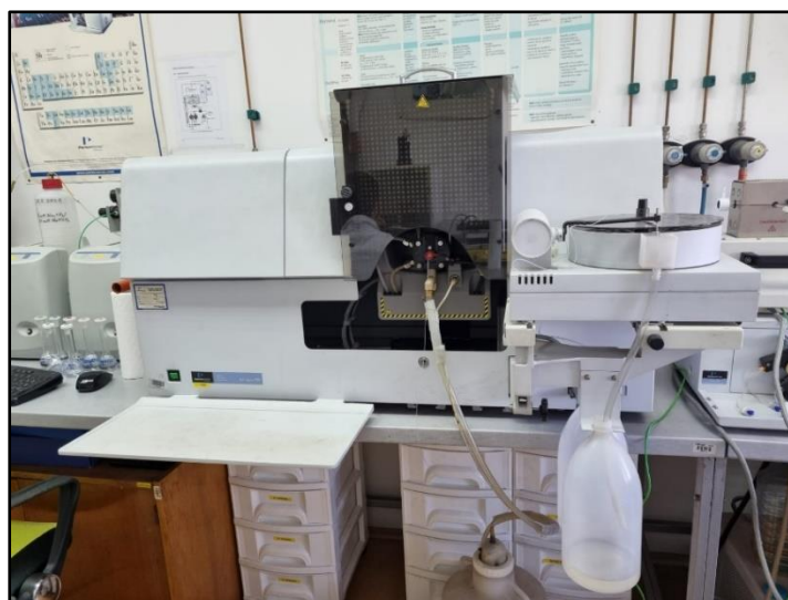
Slika 3.6. Atomski apsorpcijski spektrometar PerkinElmer AAnalyst™ 700 Atomic Absorption Spectrometer (foto: Lara Antoš).
