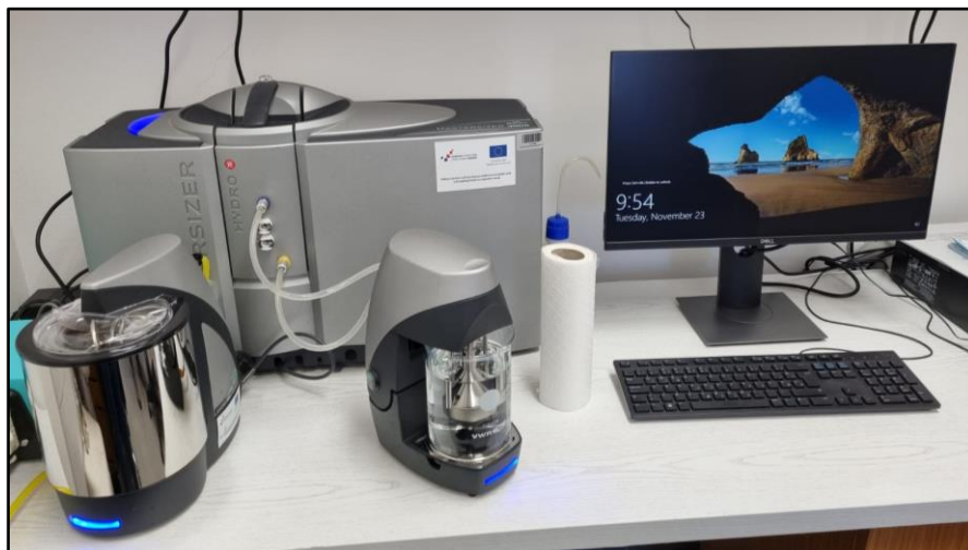
Slika 3.10. Malvern Panalytical Mastersizer 3000 na Rudarsko-geološko-naftnom fakultetu (foto: Lara Antoš).
