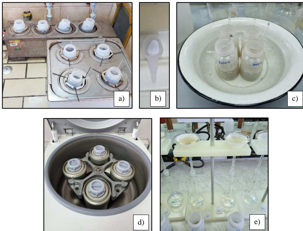
Slika 3.7. Slijed postupaka kod DCB metode: a) kivete stavljene na parnu kupelj; b) 1 g natrijevog ditionita; c) hlađenje sadržaja u kivetama; d) kivete stavljene u centrifugu; e) filtracija (foto: Lara Antoš).
