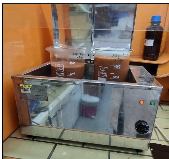
Slika 3.15. Prosjev u čašama od 5 l stavljen na uparavanje u vodenu kupelj (foto: Lara Antoš).
