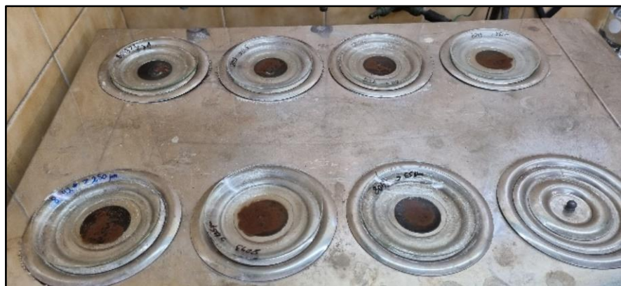
Slika 3.14. Uzorci na satnim staklima stavljeni sušiti na vodenu kupelj (foto: Lara Antoš).
