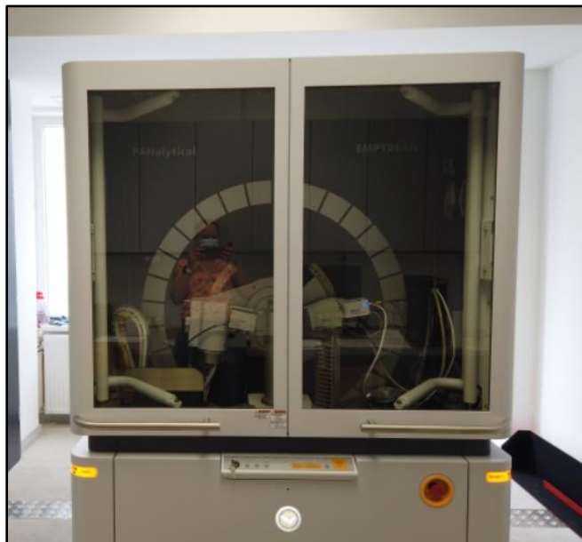
Slika 3.18. Rendgenski difraktometar Malvern Panalytical Empyrean na Rudarsko-geološko-naftnom fakultetu (izvor: Šestar, 2020).
