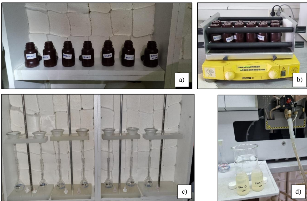
Slika 3.8. Slijed postupaka kod oksalat metode: a) tamne polibočice; b) uzorci u polibočicama stavljeni na tresilicu; c) aparatura za filtriranje; d) otopine spremne za analizu na AAS-u (foto: Lara Antoš).
