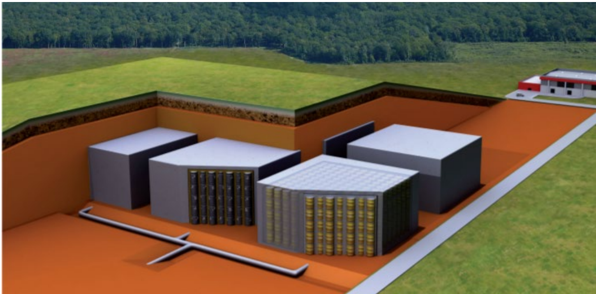
Slika 2.9. Prikaz presjeka odlagališta l'Aube, betonskih kaseta napunjenih otpadom i zatvorenim betonskim poklopcem, drenažni sloj za odvodnju oborinskih voda te konačno zatrpane kasete s debelim slojem gline (Andra, Nuclear waste in France).
