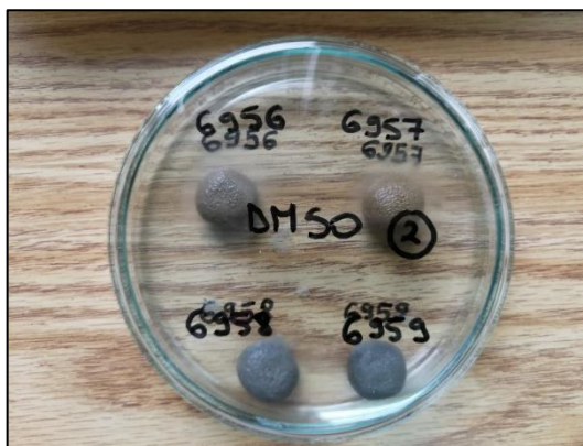
Slika 7- 13 Uzorci boksita tretirani DMSO-om.
