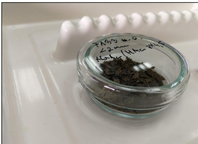
Slika 8 - 18 Neotopljeni ostatak uzorka 7133 nakon otapanja u NaAc/HAc pH 4,5.
