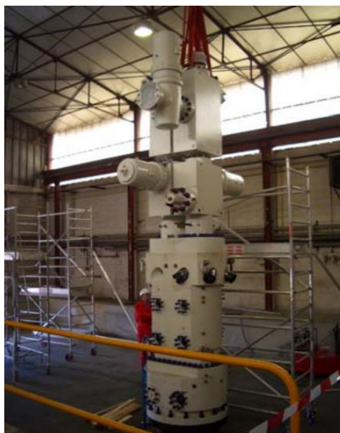
Slika 4-2. Dvostruka bušotinska glava (Bourassa et al., 2008)
