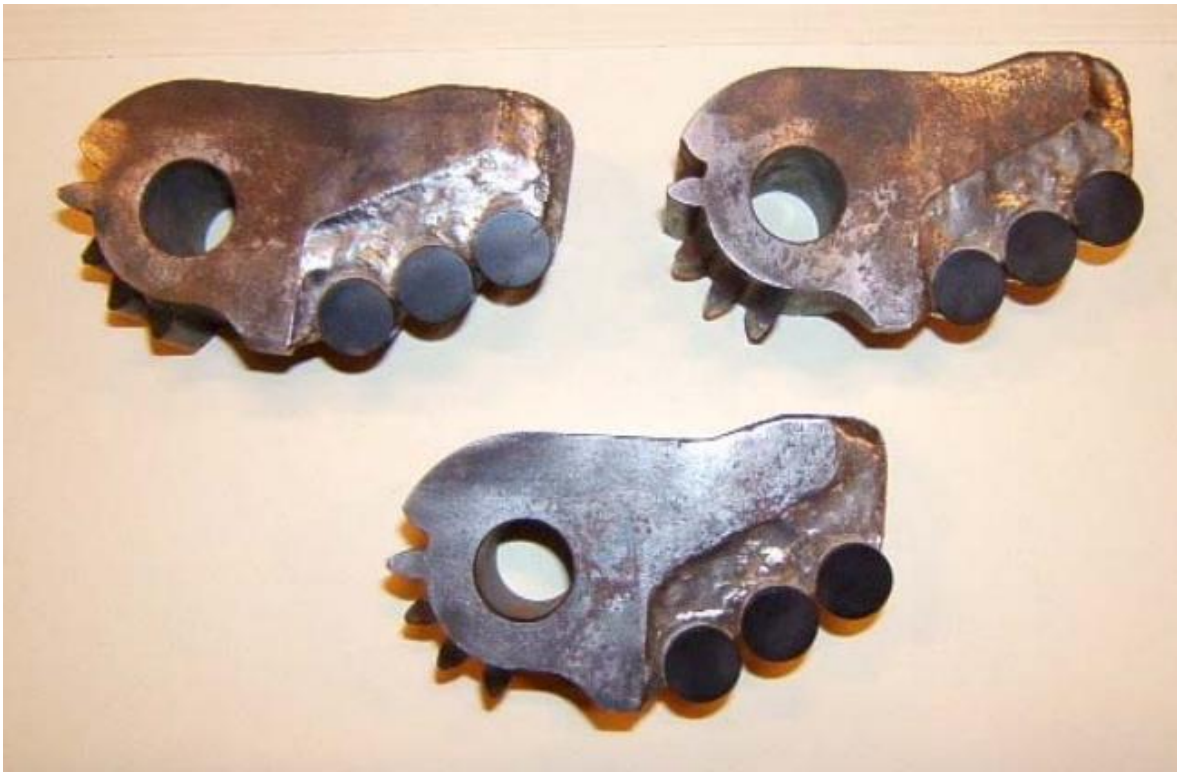
Slika 4-6. Rezni elementi proširivača nakon upotrebe tijekom bušenja dionice kanala bušotine B-16A (Bourassa et al., 2008)
