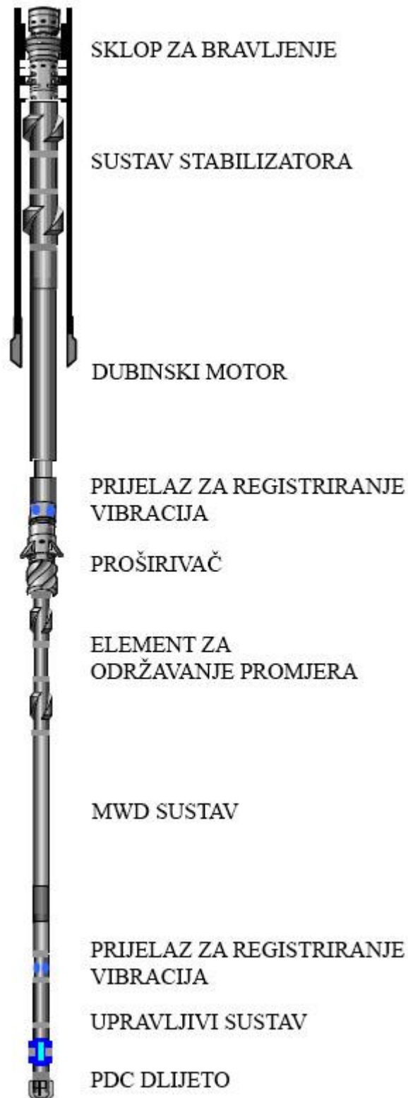
Slika 4-5. Korišteni sklop alatki na dnu za izradu usmjerene bušotine B-16A (Bourassa et al., 2008)
