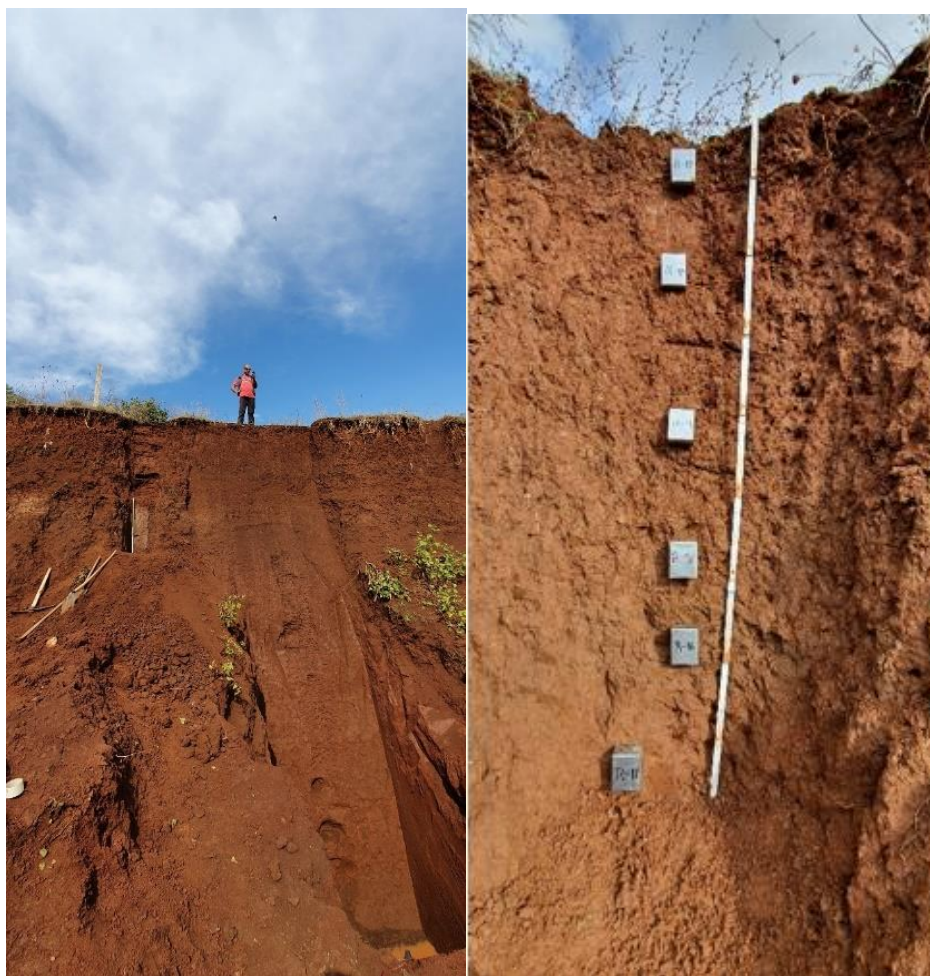
Slika 3.2. Slika profila i postavljenih Kubiens kutija za mikromorfološka istraživanja (foto: G. Durn)
