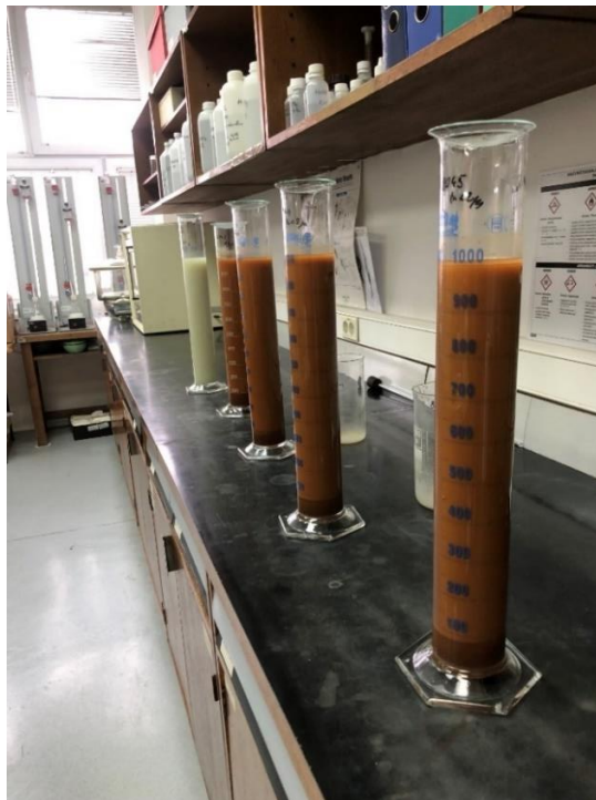
Slika 3.19. Suspenzija čestica <32\ \mu\text{m} u cilindrima za sedimentaciju (foto: Fran Vrdoljak)
