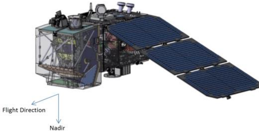
Slika 3-8 Shematski prikaz rasporedene svemirske letjelice Sentinel-2 (ESA, 2015)
