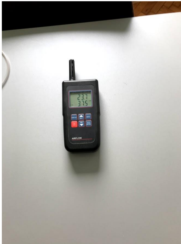
Slika 4-3 Termo-Hygro barometar THB 4130D
