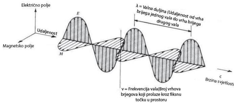
**Slika 3.2** Elektromagnetski val. Komponente uključuju sinusoidni električni val (E) i slični magnetski val (M) pod pravim kutom u odnosu na električni val, oba vala okomita su smjer širenja. (Lilesand et al. 2015)
