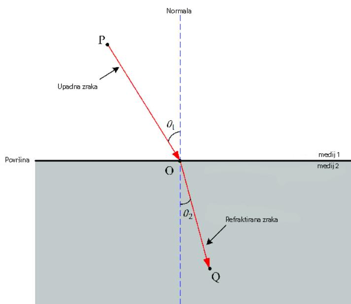
**Slika 3.6** Princip refrakcije (Long et al. 2019)
