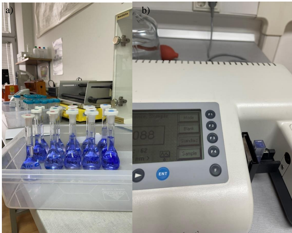
Slika 6–9. a) Pripremljeni uzorci za analizu kapaciteta kationske zamjene metodom Cu–trien, b) Zeiss SPEKOL 1100 spektrofotometar.
