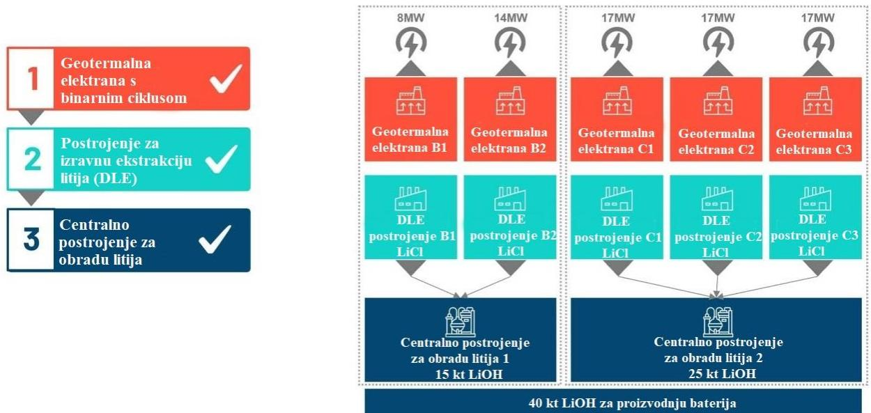
Slika 6-3. Struktura projekta Zero Carbon Lithium (Vulcan Energy, 2021)
