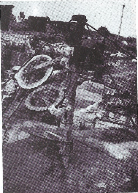
Sl. 13. Kamenolom Fantazija u Isri. Vodilica za helikoidalnu žicu "usadena" u stijenu
