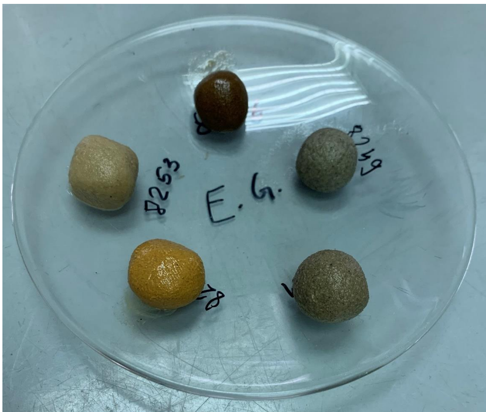
Slika 6.3. Tretiranje uzoraka etilen glikolom (EG)
