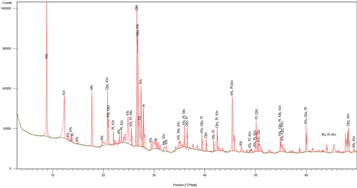
Slika 7.2. Difrakcijska slika netretiranog uzorka MT68 (Legenda: Ms-muskovit, Kln-kaolin, Pl-plagioklas, Kfs-K-feldspat, Qtz-kvarc).
