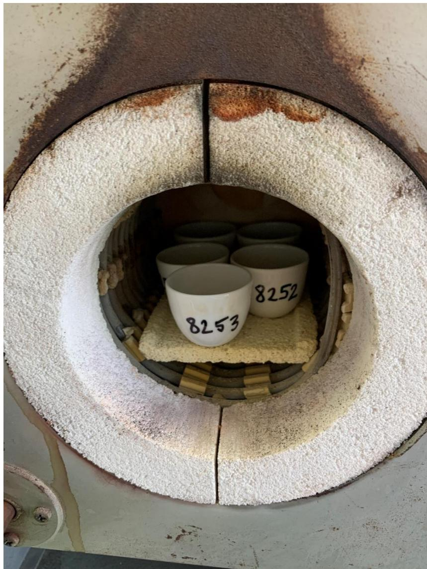
Slika 6.4. Žarenje uzorka na  $350\text{ }^{\circ}\text{C}$  i  $550\text{ }^{\circ}\text{C}$
