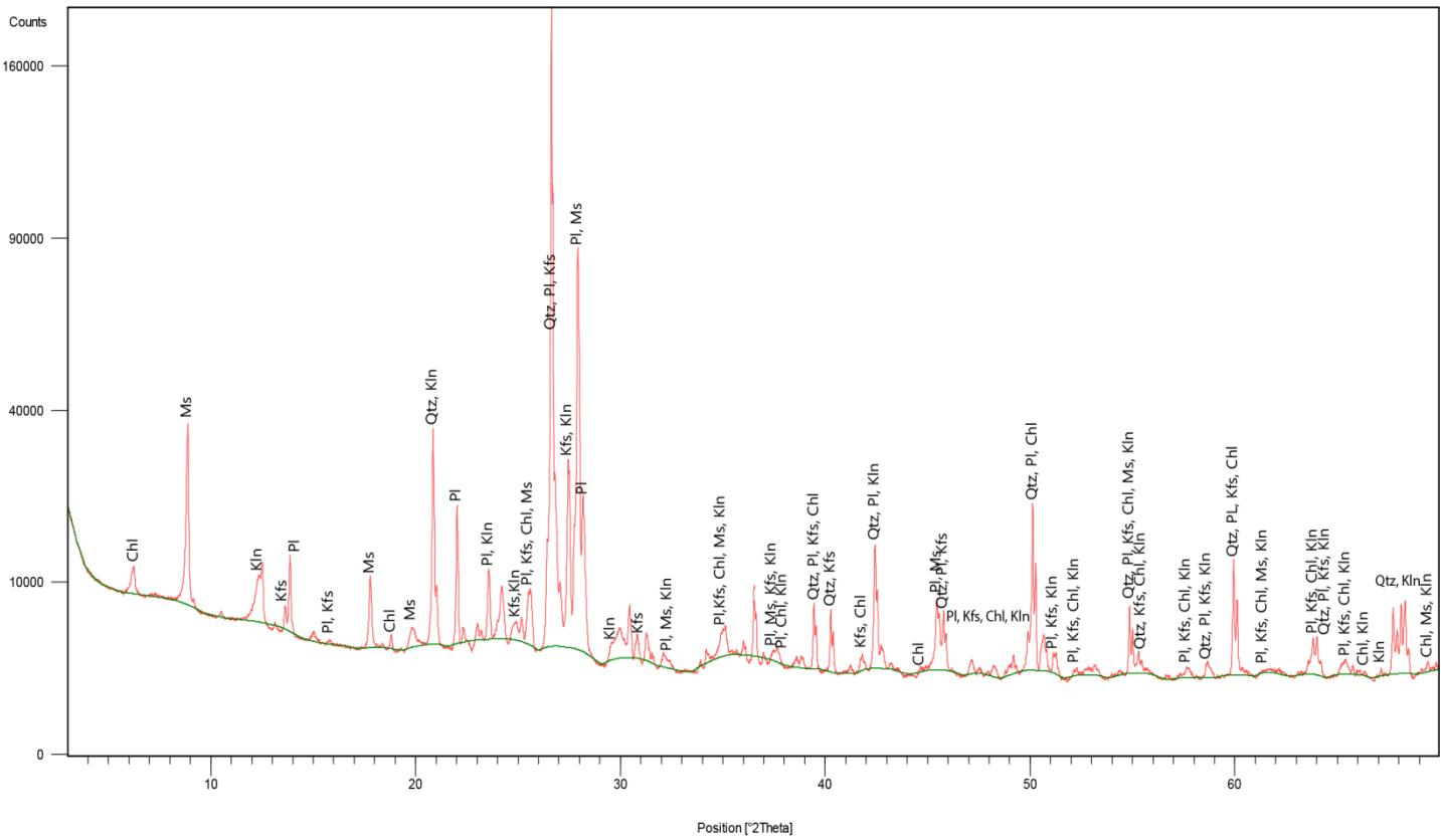
Slika 7.1. Difrakcijska slika netretiranog uzorka MT64 (Legenda: Chl-klorit, Ms-muskovit, Kln-kaolin, Pl-plagioklas, Kfs-K-feldspat, Qtz-kvarc).
