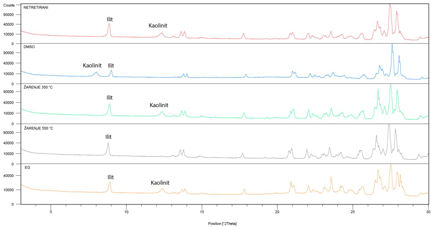
Slika 7.9. Prikaz difrakcijske slike uzorka MT72A netretiranog, tretiranog dimetilsulfoksidom (DMSO metoda), tretiranog etilenglikolom te žarenog na 350 °C i 550 °C.
