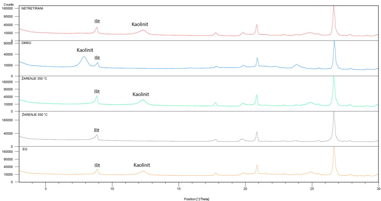
Slika 7.10. Prikaz difrakcijske slike uzorka PR5 netretiranog, tretiranog dimetilsulfoksidom (DMSO metoda), tretiranog etilenglikolom te žarenog na 350 °C i 550 °C
