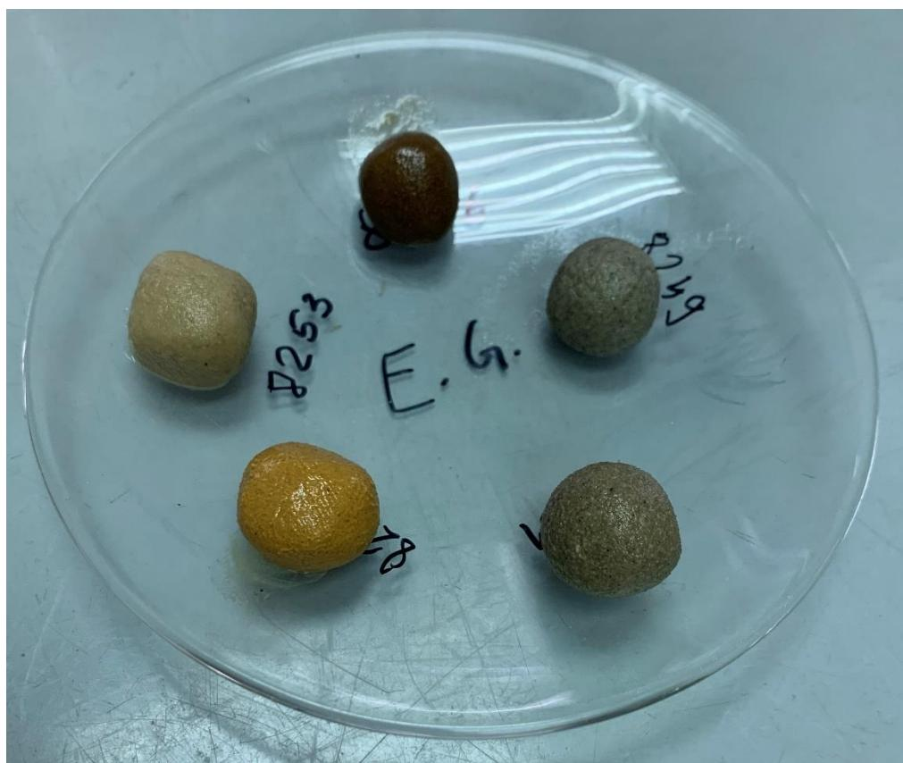
Slika 6.3. Tretiranje uzoraka etilen glikolom (EG)
