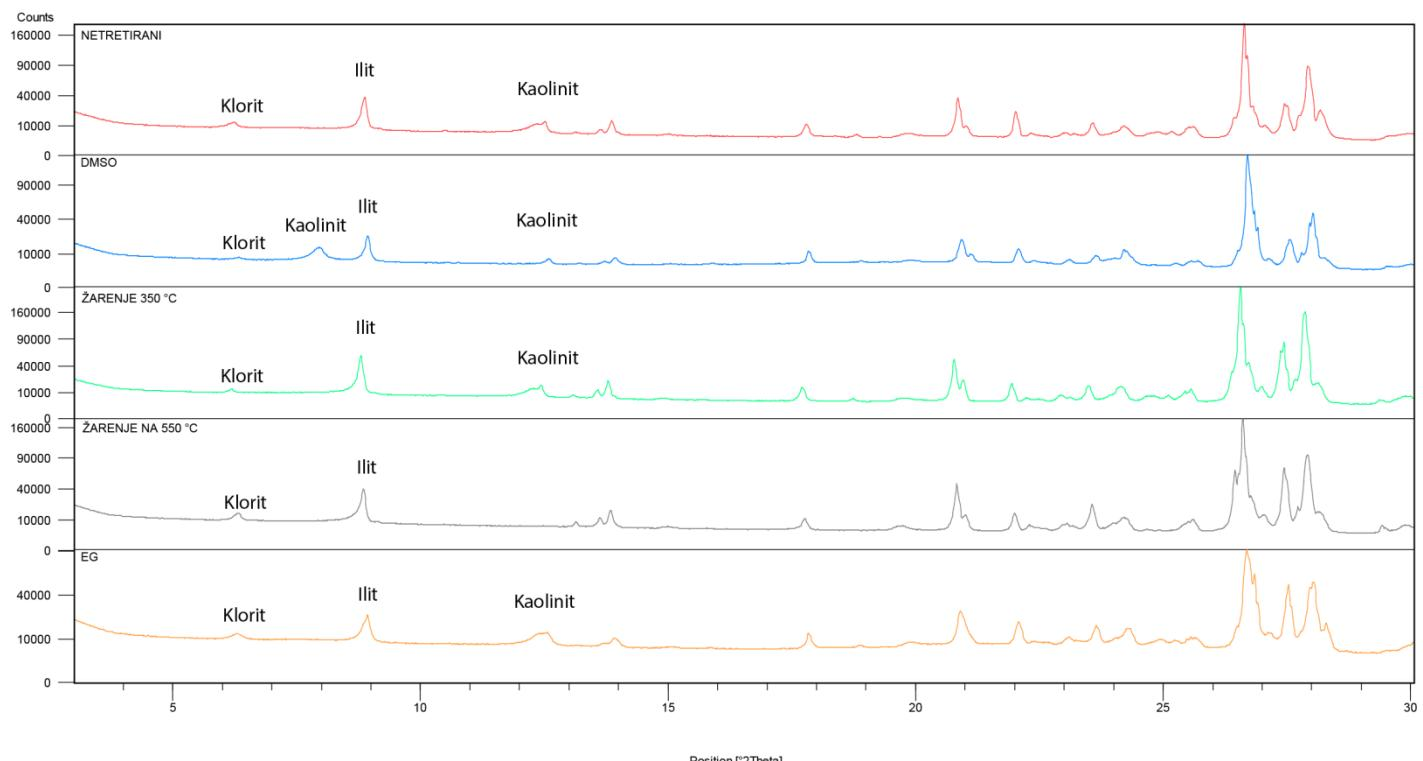
Slika 7.6. Prikaz difrakcijske slike uzorka MT64 netretiranog, tretiranog dimetilsulfoksidom (DMSO metoda), tretiranog etilenglikolom te žarenog na 350 °C i 550 °C.
