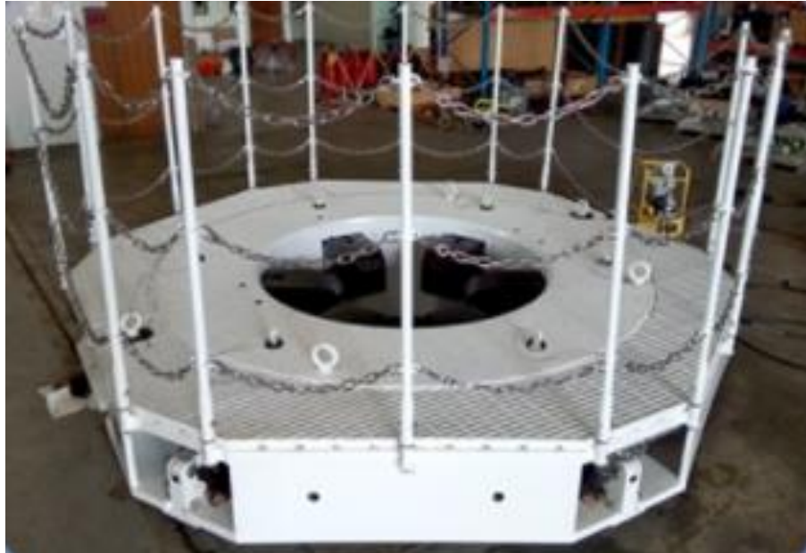
Slika 8-1. Stol s čeljustima za ugradnju niza usponskih cijevi ( https://www.nustar-tech.com , 2012)
