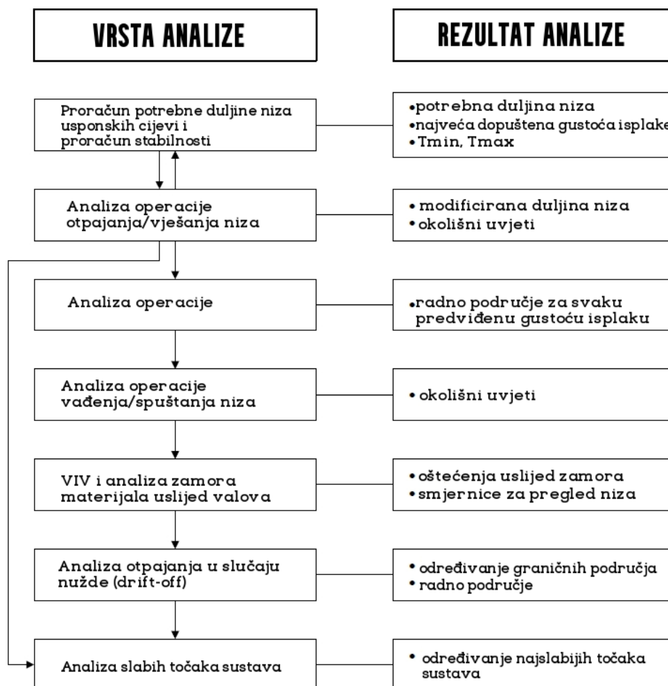
Slika 3-2. Hodogram za odabir sustava usponskih cijevi (ABS, 2017)
