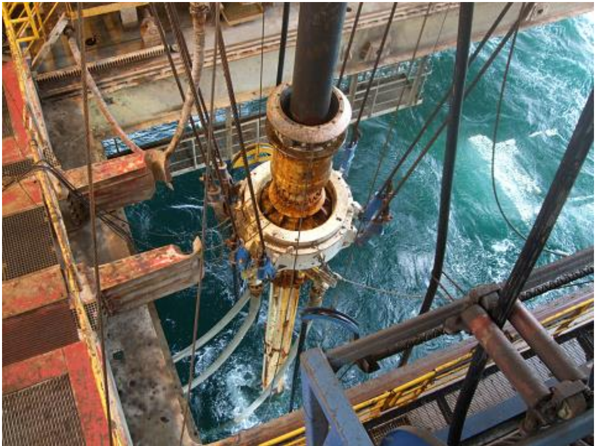
Slika 5-2. Prikaz teleskopske spojnice u radnom okruženju (www.istockphoto.com, 2011)
