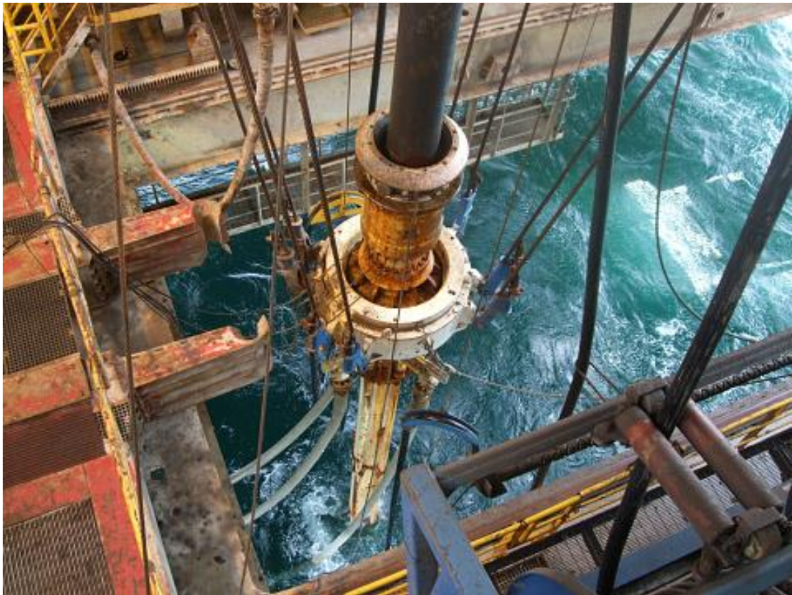
Slika 5-2. Prikaz teleskopske spojnice u radnom okruženju (www.istockphoto.com, 2011)
