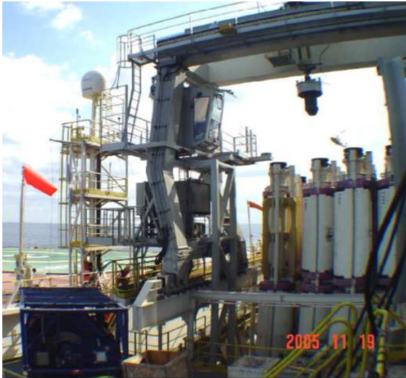
Slika 8-3. Prikaz hidraulične alatke za rukovanje usponskim cijevima na podištu tornja (Aker Solutions, 2010)
