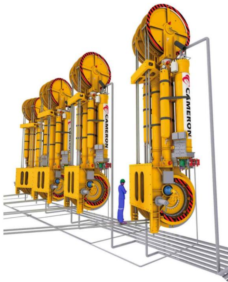
Slika 6-1. Prikaz komponenata nateznog sustava usponskih cijevi (Laik, 2018)
