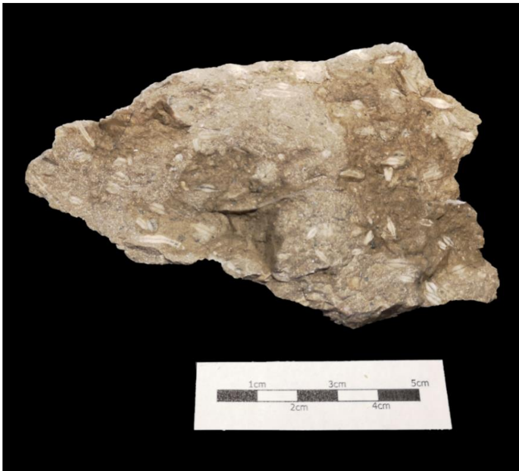
Slika 5-7. Uzorak prvog litotipa Neformalne litostratigrafske jedinice 3 s fosilnim ostacima foraminifera iz skupine ortofragminida. Točka T21.
