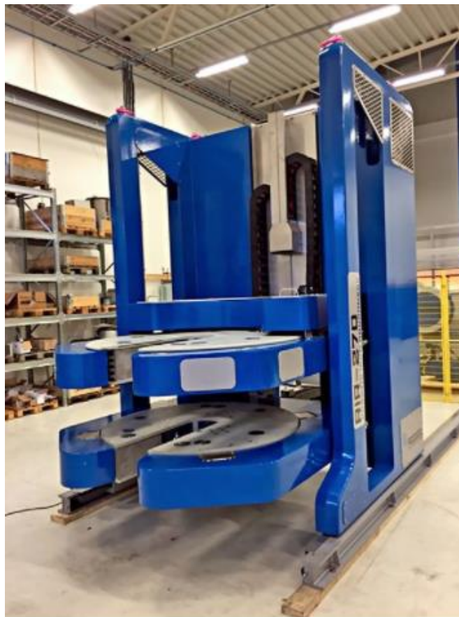
Slika 5-3. Električni robotizirani sustav za navrtanje/odvrtanje bušaćih alatki RRN-250 (Nabors, 2021c)
