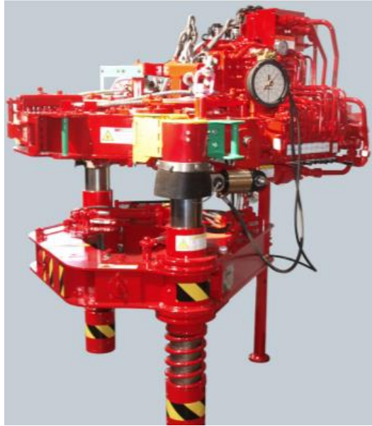
Slika 3-17. 14-50 hidraulička kliješta za ostvarivanje velikog momenta dotezanja tvrtke Weatherford (Weatherford, 2014)
