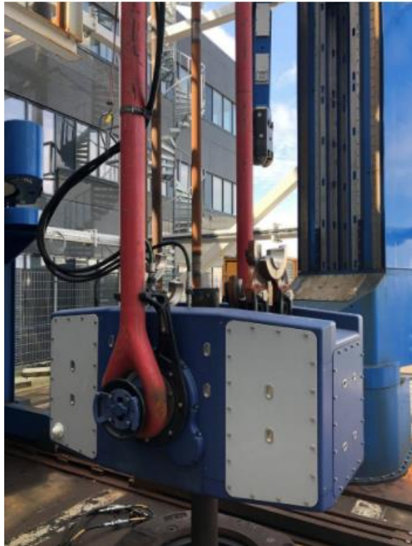
Slika 5-4. Robotizirani elevator s varijabilnim insertima za prihvat alatki različitog promjera MSE-500 (Nabors, 2021d)
