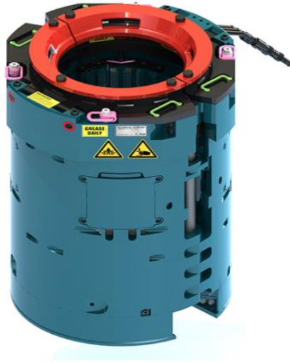
Slika 4-5. Hidraulički automatski klinovi PS-350 tvrtke Forum Energy Technologies (FET, 2021)
