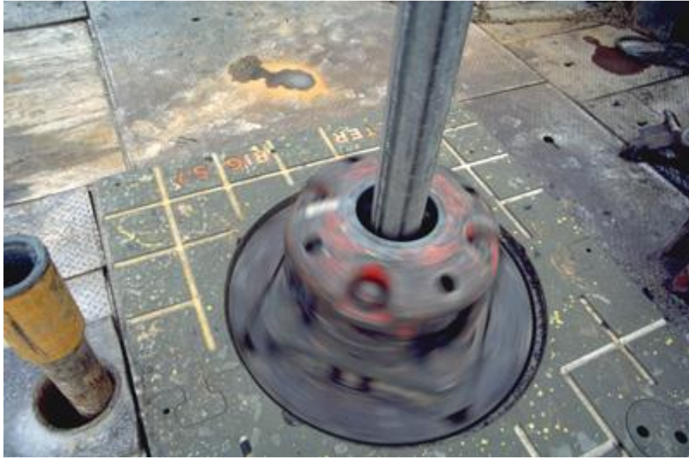
Slika 3-1. Kupola radne šipke unutar kupole vrtaćeg stola tijekom prijenosa rotacije na niz bušaćih alatki te bušaća šipka odložena u mišjoj rupi (Schlumberger Oilfield Glossary, 2021)
