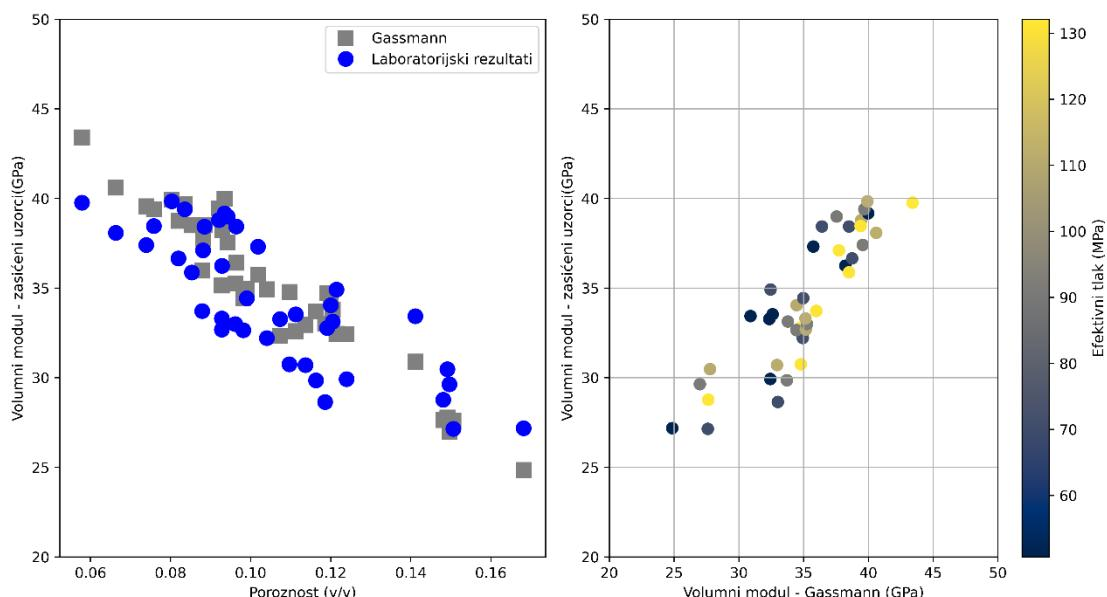
Slika 13-2 Odnos poroznosti i volumnog modula zasićenih uzoraka dobivenih laboratorijskim mjeranjima i izračunatih pomoću Gassmannove jednadžbe (lijevo) i odnos volumnog modula zasićenih uzoraka dobivenih laboratorijskim mjeranjima i izračunatih pomoću Gassmannove jednadžbe (desno). Ulagani parametri za kalcit:  $K = 76.8 \text{ GPa}$ , voda  $K = 2.1 \text{ GPa}$
