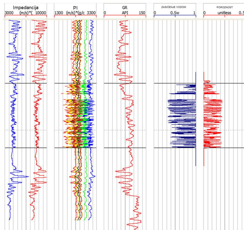
Slika 10-21 Bušotinski profil s prikaznim krivuljama impedancija, Poissonovih impedancija s različitim vrijednostima koeficijenta  $c$ , mjerena prirodne radioaktivnosti, zasićenja vodom i poroznosti bušotine A-1Z
