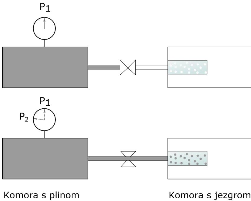
Slika 9-4 Princip mjerena poroznosti volumetrijskom metodom
