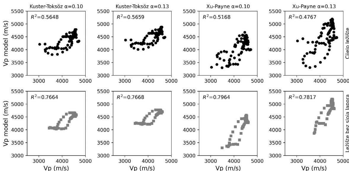
Slika 8-6 Dijagram  $V_p$ - $V_p$  koji prikazuje odnos izmjerjenih brzina u bušotini i modeliranih brzina za različite teoretske modele i to za cijelokupno ležište i bez zone s većim udjelom laporanog voda
