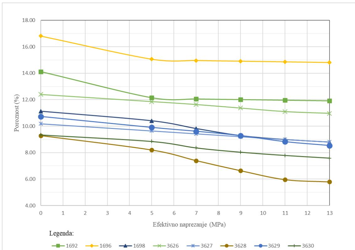
Slika 9-6 Odnos poroznosti i efektivnih naprezanja uzoraka
