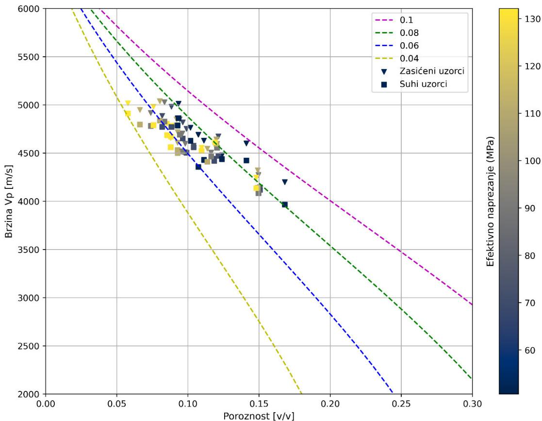
Slika 9-16 Dijagram brzina P-vala i poroznosti s definiranim modelom Kuster i Toksöz za eliptični oblik pora. Podaci su obojani vrijednostima efektivnih naprezanja. Ulagani elastični parametri:  $K=76.8 \text{ GPa}$ ,  $\mu=32 \text{ GPa}$ ; slojna voda  $K = 2.1 \text{ GPa}$
