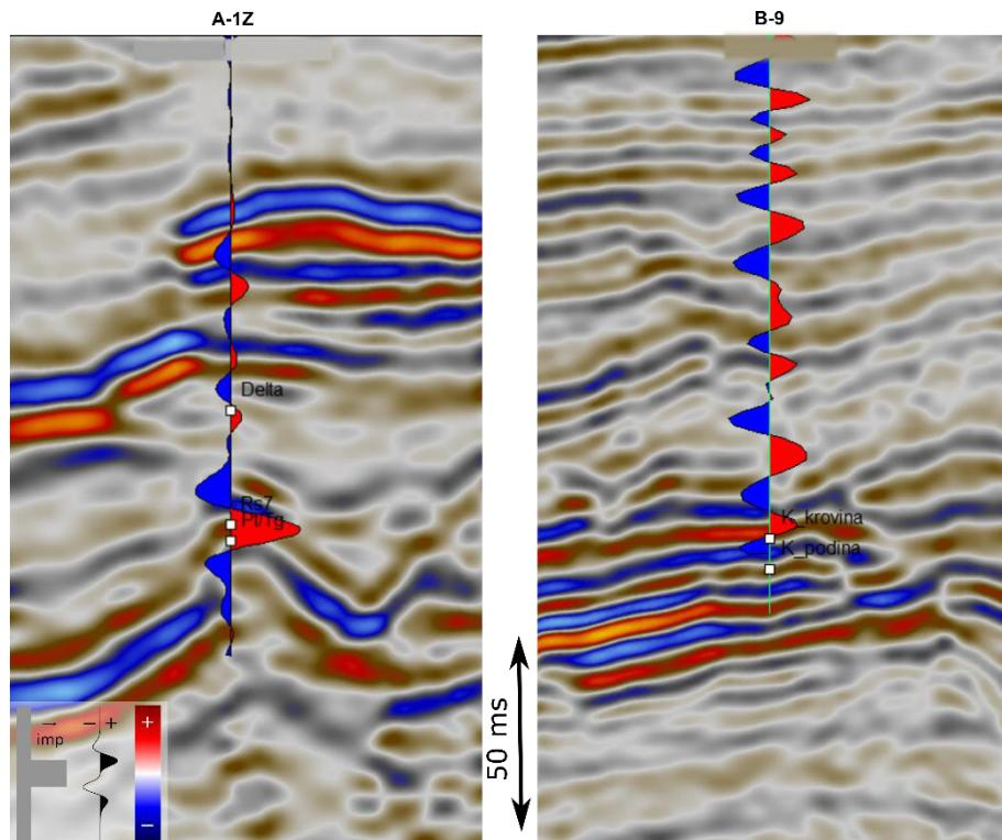
Slika 4-12 Kalibrirani sintetski trag na seizmičkom profilu za bušotine A-1Z i B-9
