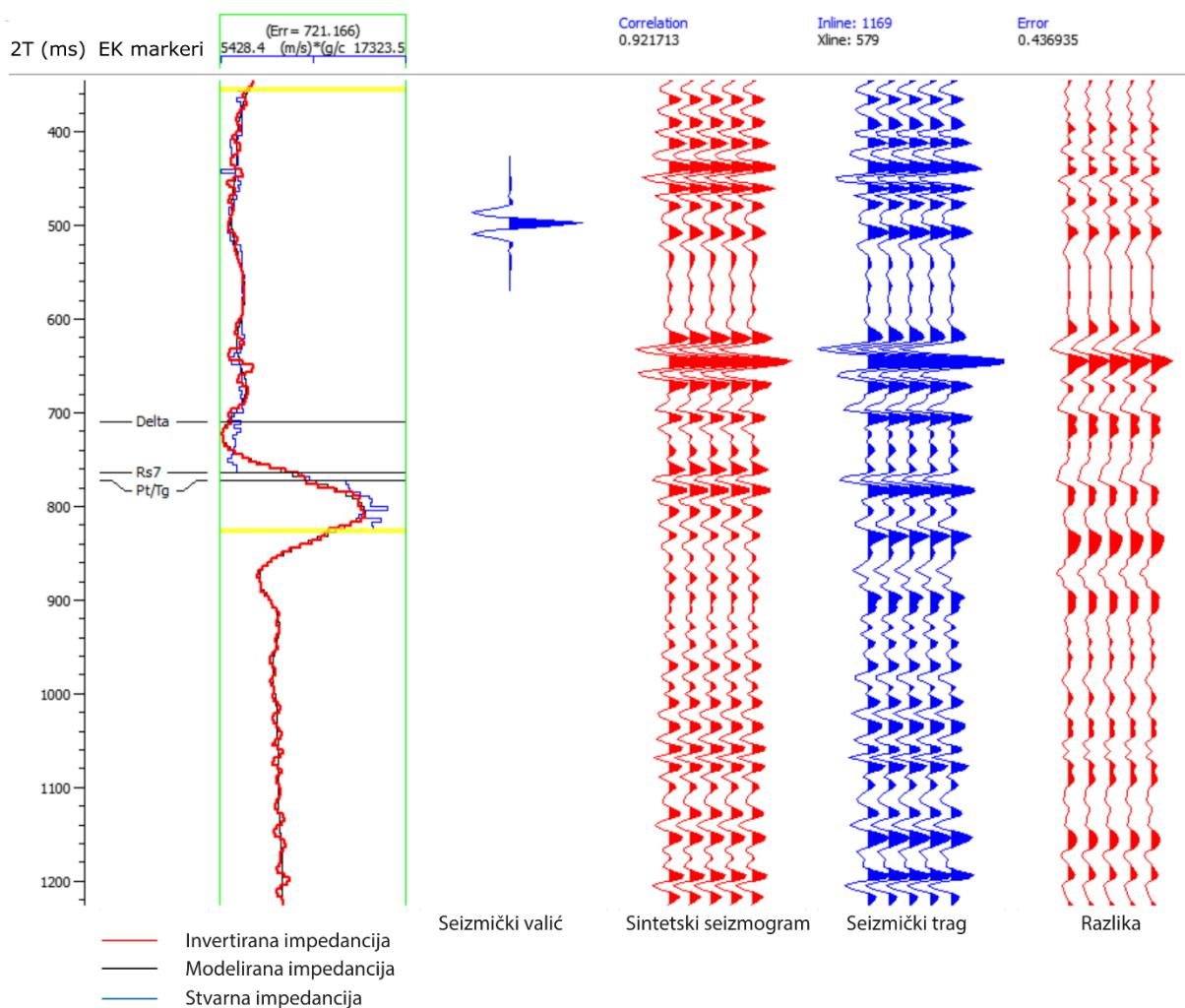
Slika 10-4 Korelacija sintetskog seismograma i snimljenog seizmičkog traga tijekom procesa inverzije za bušotinu A-1Z na Grubišnom Polju
