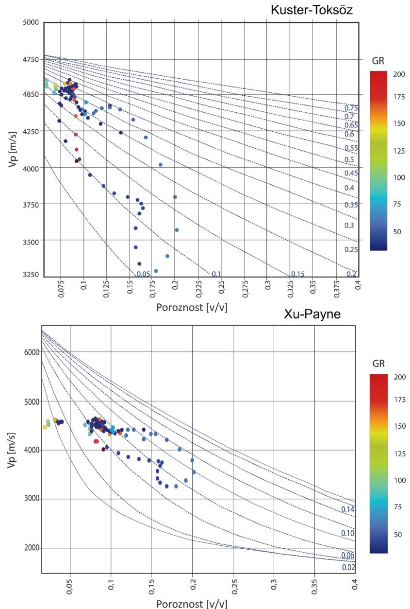
Slika 8-4 Odnos brzina P-valova i poroznosti s naznačenim krivuljama koeficijenta pora ( $\alpha$ ) za model Kuster-Toksöz (gore) i model Xu-Payne (dolje). Vrijednosti gama karotaže (GR) su naznačene spektrom boja. (Ulagani parametri su: kalcit  $K=68$  GPa,  $\mu=28$  GPa,  $Sw 26\%$ , voda  $K=2.2$  GPa,  $\rho=1.0$  g/cm $^3$ , plin  $K=0.038$  GPa,  $\rho=0.15$  g/cm $^3$ )
