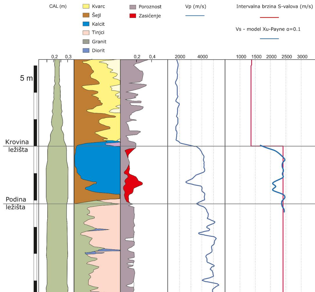
Slika 8-7 Litološki profil bušotine A-1Z s rezultatima modeliranja brzina
