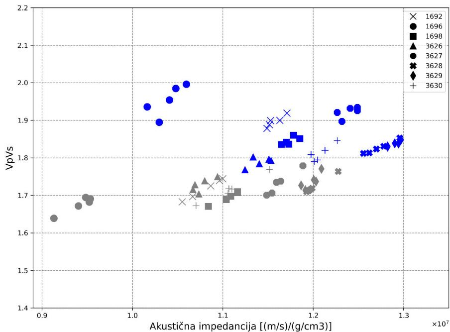
Slika 9-23 Dijagram ovisnosti  $V_p/V_s$  koeficijenta i akustičnih impedancija suhih (sivo) i zasićenih (plavo) uzorka
