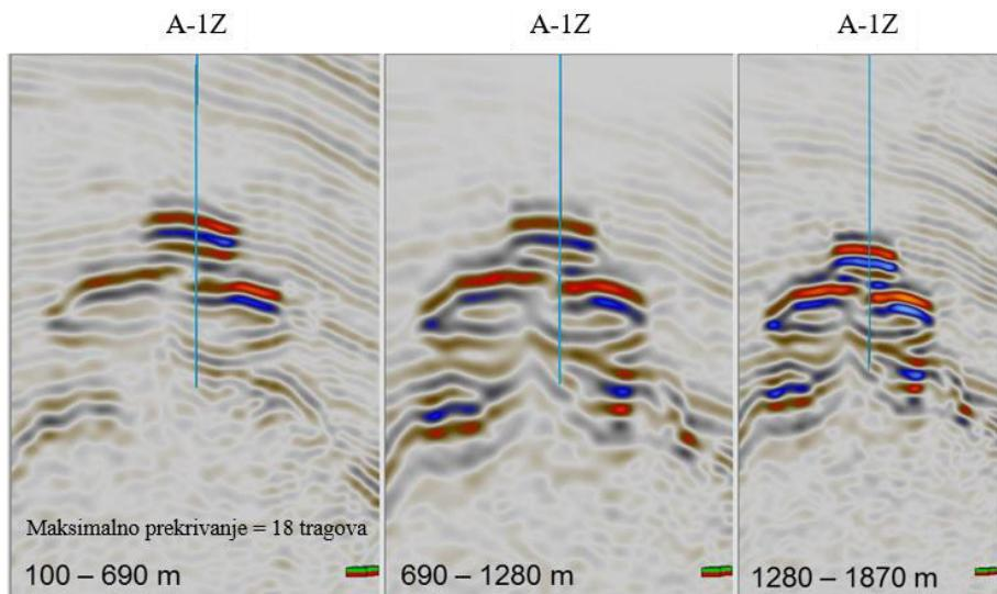
Slika 4-4 Usporedba profila *offset stack* s različitim udaljenostima
