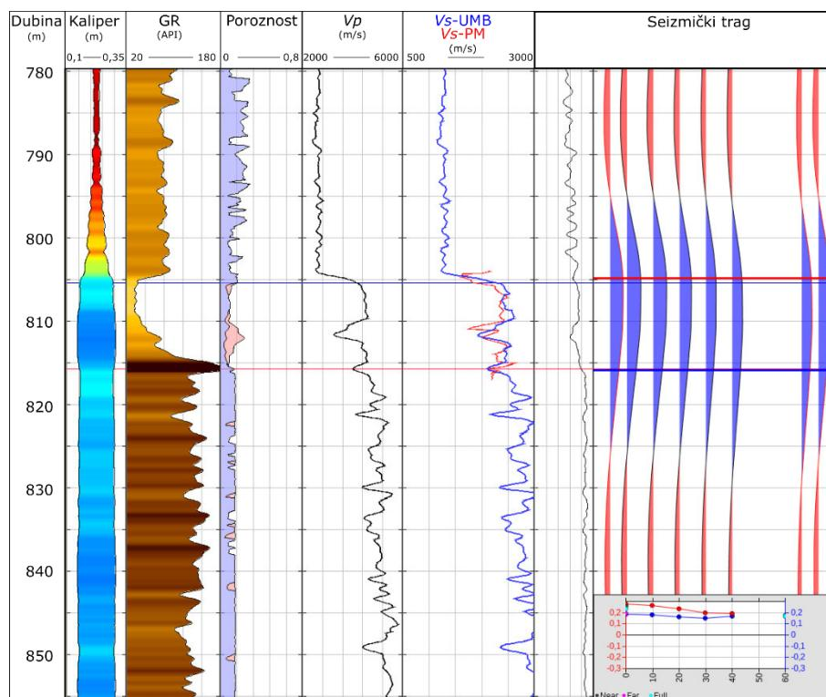
Slika 13-1 Usporedba krivulja  $V_s$  dobivenih na temelju ultrazvučnog mjerena i petrofizikalnog modeliranja ( $V_s$ -UMB brzina S valova dobivena ultrazvučnim mjerjenjima primjenom formule 9-11;  $V_s$ -PM brzina S valova dobivena petrofizikalnim modeliranjem)
