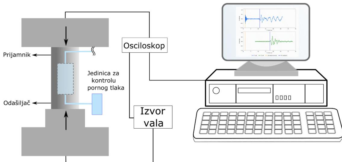
Slika 9-8 Skica uređaja za ultrazvučno mjerjenje brzina
