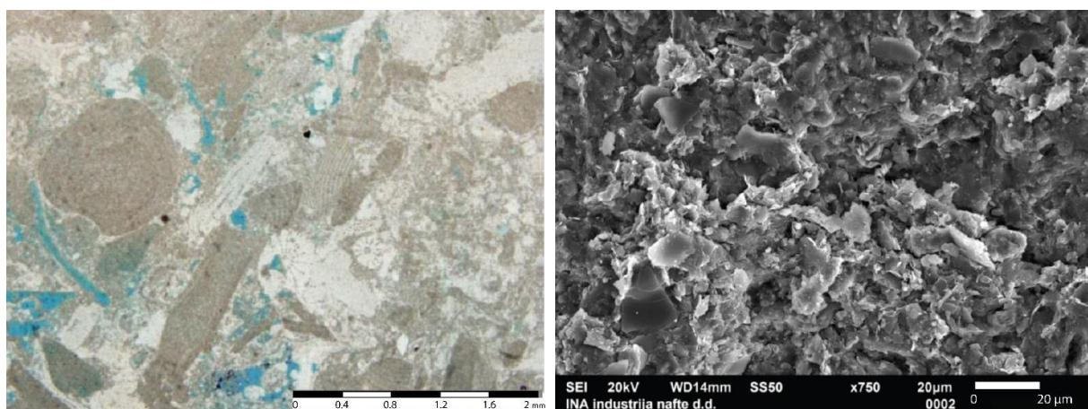
Slika 8-1 Mikroskopski prikaz sekcije (uvećanje 40x) prikazuje mikro poroznost u vapnencu (lijevo) i morfološki prikaz uzorka snimljen elektronskim mikroskopom (uvećanje 750x) (desno) (Matošević et al., 2017)
