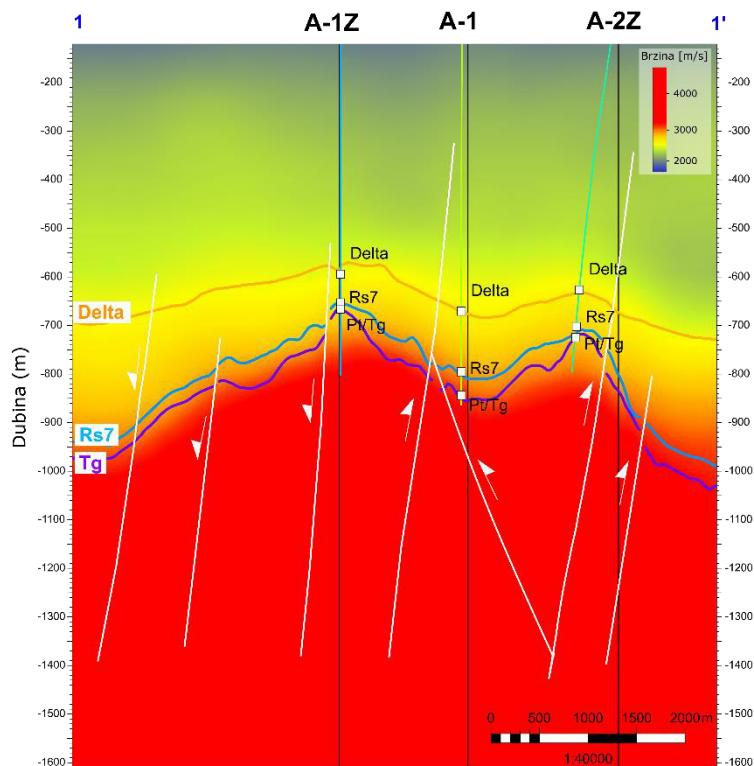
Slika 5-4 Profil 1-1' s prikazanim intervalnim brzinama iz 3D modela brzina
