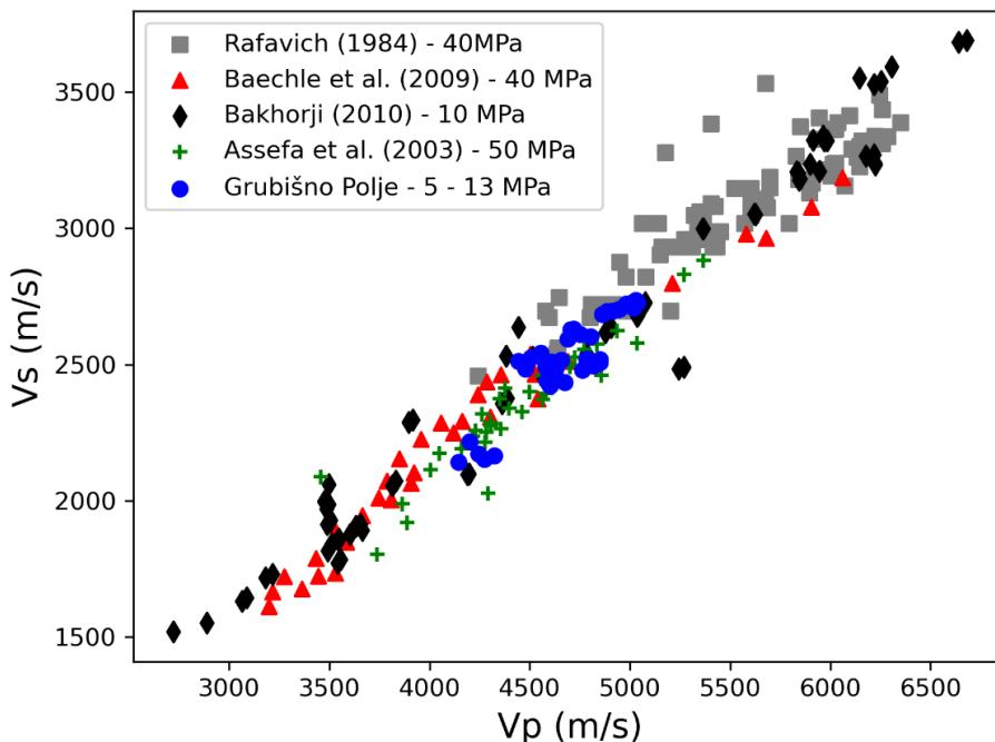
Slika 9-22 Odnos  $V_p$ - $V_s$  brzina Grubišnog Polja uspoređen s rezultatima iz literature različitih vrijednosti efektivnog naprezanja i dubina
