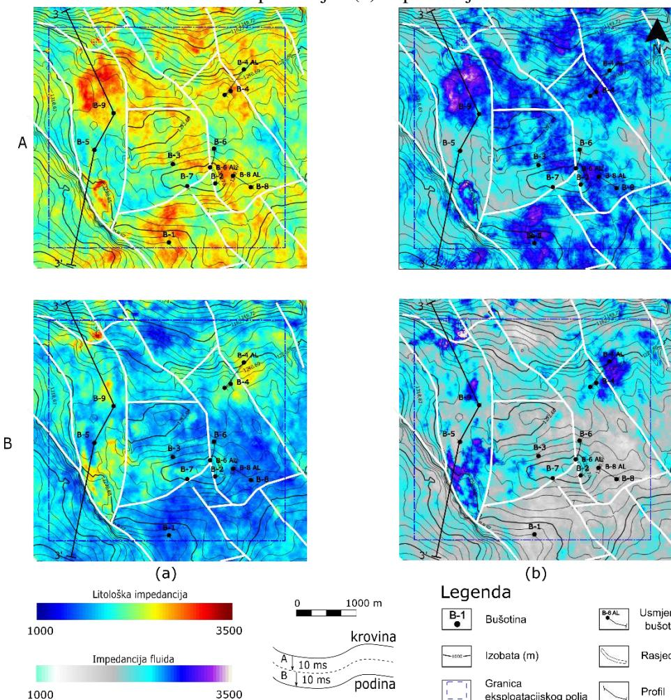
Slika 10-24 Atributne karte rezultata Poissonove impedancije polja Letičani: (a) litološka impedancija i (b) impedancija fluida prikazane za dvije vertikalne zone po 10 ms (A i B)
