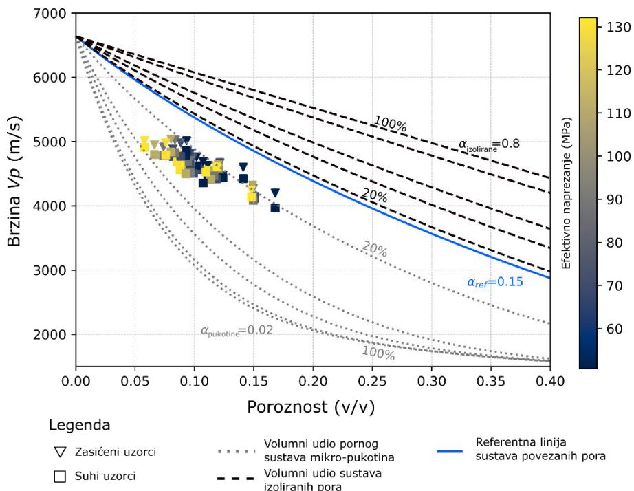
Slika 9-17 Dijagram brzina P-vala i poroznosti s definiranim modelom Xu Payne. Podaci su obojani vrijednostima efektivnih naprezanja. Ulagani elastični parametri:  $K = 76.8 \text{ GPa}$ ,  $\mu = 32 \text{ GPa}$ ; slojna voda  $K = 2.1 \text{ GPa}$
