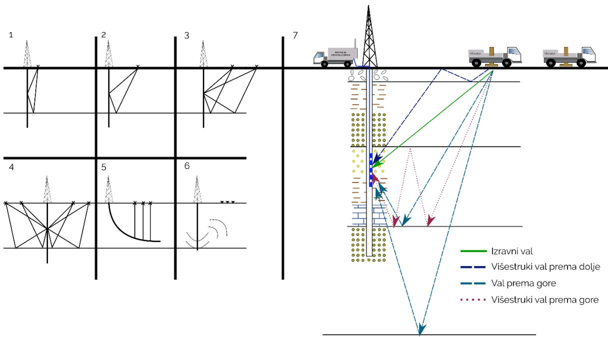
Slika 4-9. Geometrija VSP mjeranja: 1. bez odmaka (engl. *zero-offset VSP*), 2. s odmakom (engl. *offset VSP*), 3. mjerjenje s višestrukim izvorima (engl. *multi-offset VSP*), 4. paralelnim pomicanjem izvora vala (engl. *walk-away VSP*), 5. paralelnim pomicanjem izvora vala i geofona (engl. *walk-above VSP*), 6. snimanje seizmičkih valova tijekom bušenja (engl. *seismic while drilling VSP*) i 7. geometrija širenja seizmičkih valova (prema Gupta, 2011).
