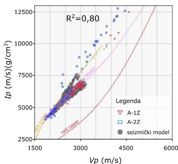
Slika 11-3 Dijagram odnosa brzina  $V_p$  i P-impedancija  $I_p$  seizmičkog modela za dubinu kontakta plin-voda od -752 m i bušotinskih podataka u buštinama A-1Z i A-2Z.
