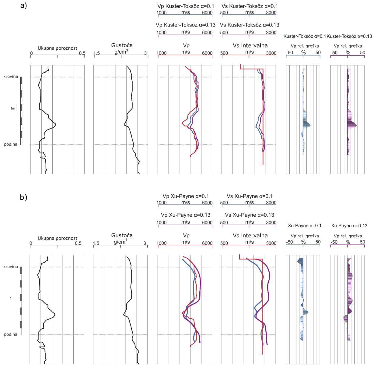
Slika 8-5 Prikaz bušotinskih krivulja za buštinu A-1Z s vrijednostima ukupne poroznosti, gustoće, mjereneih brzina P-valova, intervalne brzine S-valova izračunate iz VSP-mjerenja, modelirane brzine P- i S- valova i relativne pogreške brzine P-valova; a) model Kuster-Toksöz, b) model Xu-Payne
