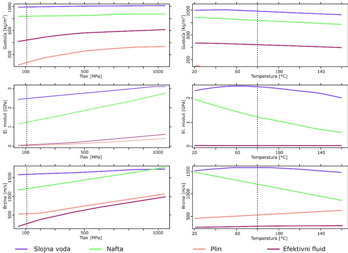
Slika 7-8 Dijagrami ovisnosti gustoće, brzine i volumnih modula ležišnih fluida polja Grubišno Polje o promjeni tlaka i temperature. (efektivno naprezanje 11 MPa, temperatura ležišta  $80^{\circ}\text{C}$ ,  $Sw = 0,4$ ;  $Sg = 0,6$ ;  $So = 0$ , salinitet  $10 \text{ g/l}$ )
