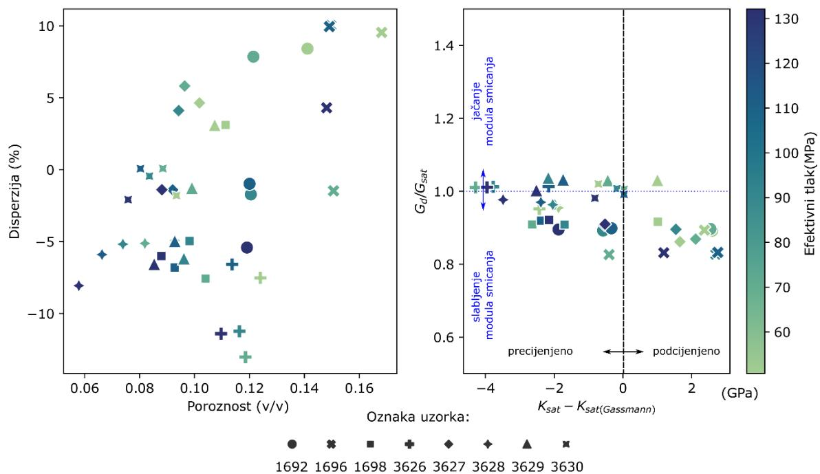
Slika 13-3 Korelacija poroznosti i disperzije volumnog modula izračunatog Gassmannovom jednadžbom (lijevo) i dijagram promjene modula smicanja ( $G_d/G_{\text{sat}}$ ) i razlike volumnog modula mјerenog i izračunatog Gassmannovom formulom ( $K_{\text{sat}} - K_{\text{sat}(Gassmann)}$ ).
