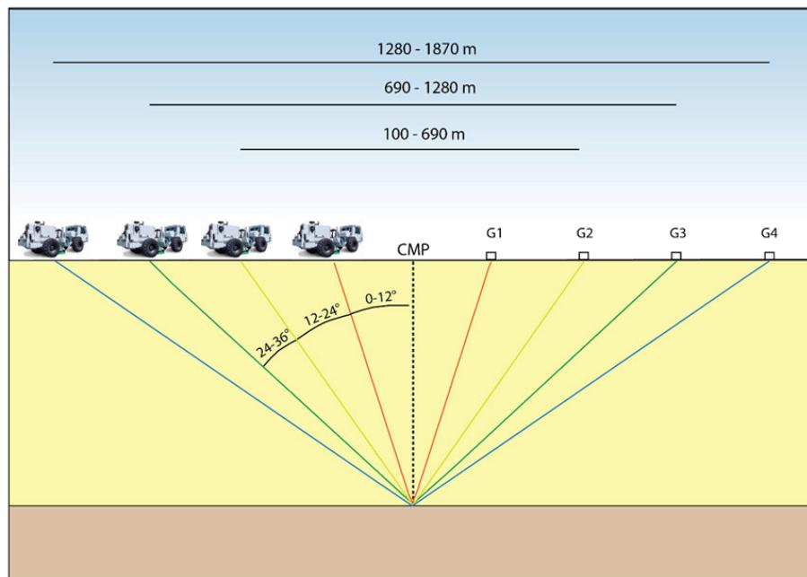
Slika 4-3 Geometrija snimanja. *Offset stack* volumen zbrojenih tragova definiran udaljenostima geofona od izvora vala; *angle stack*“ volumen zbrojenih tragova definiran kutovima upada seizmičkog vala
