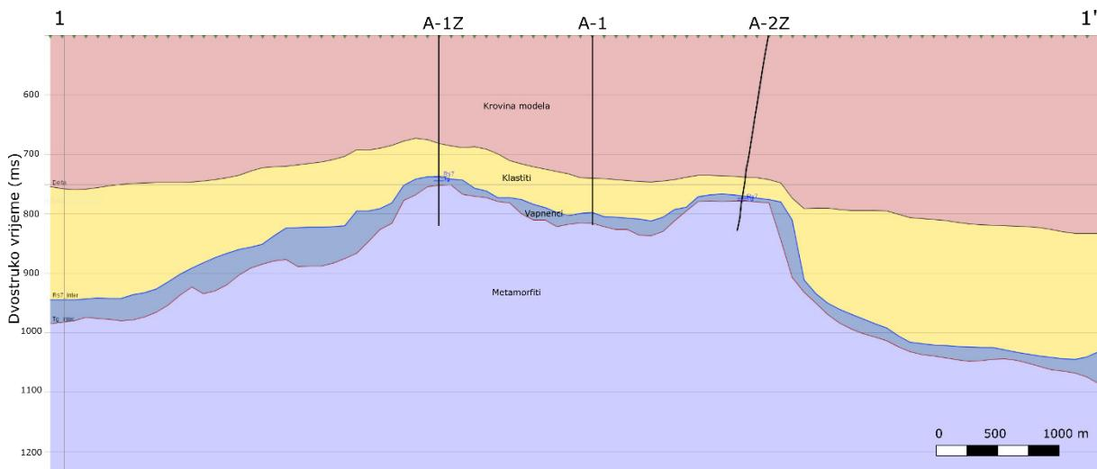
Slika 11-1 Seizmički model Grubišnog Polja konstruiran na temelju seizmičke interpretacije. Svaki sloj modela definiran je elastičnim parametrima dobiven laboratorijskim mjerjenjima i na temelju rezultata seizmičke inverzije.
