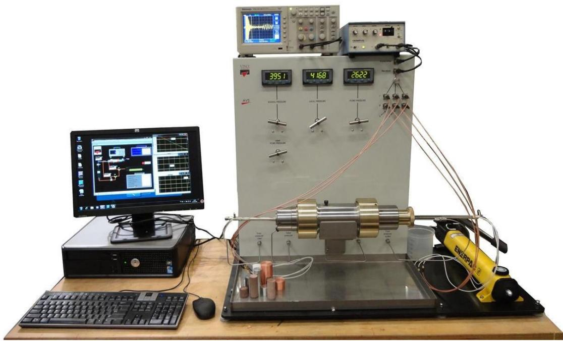
Slika 9-9 Uređaj AVS 700 korišten za mjerjenje ultrazvučnih valova koji omogućuje mjerjenje brzina pod različitim vrijednostima efektivnih naprezanja i pornog tlaka (izvor: <https://vindum.com/>, 6. 12. 2021.)
