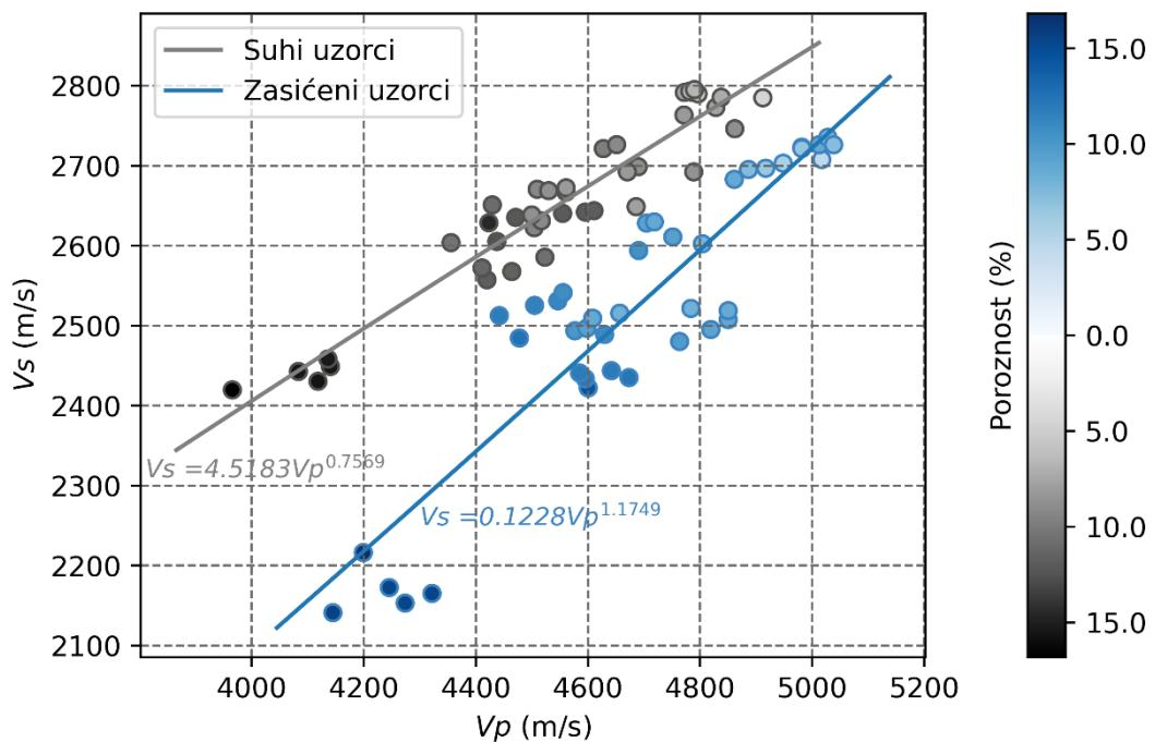
Slika 9-20 Dijagram ovisnosti P-brzina i S-brzina suhih (sivo) i zasićenih uzoraka (plavo) pri različitim efektivnim naprezanjima
