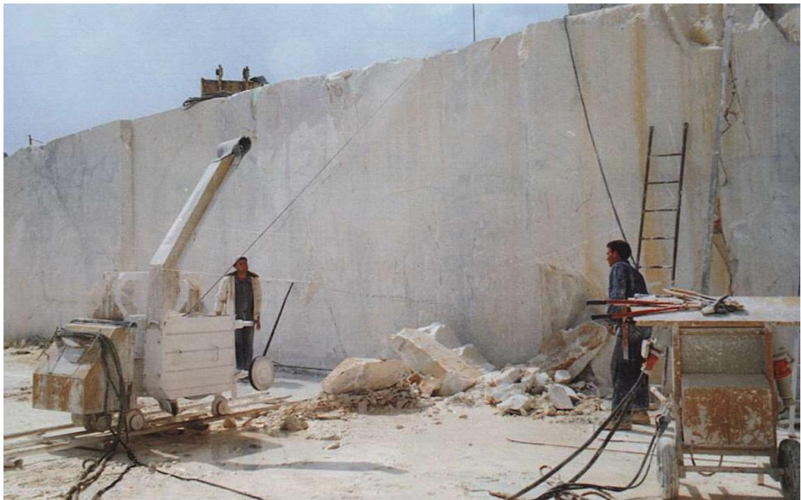
Slika 2-1: Dijamantna žična pila na ležištu (Kujundžić, 2003.)
