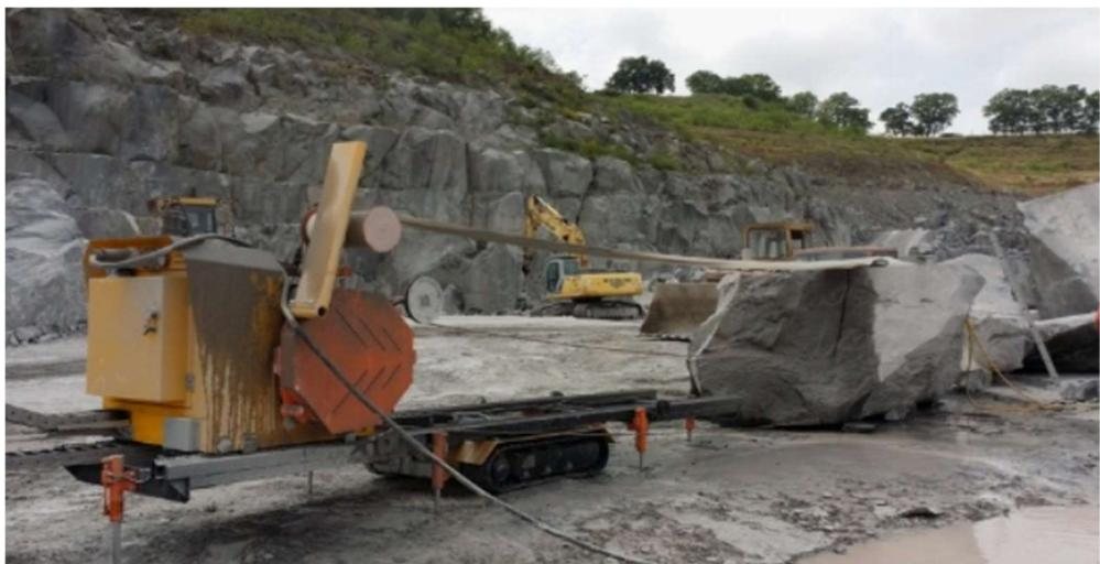
**Slika 3-14:** Dijamantna žična pila S800T (Promidžbeni materijal tvrtke Dazzini Machhine, 2010.)
