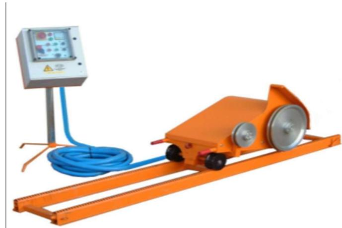
Slika 3-7: Dijamantna žična pila MICRO FIL (Promidžbeni materijal tvrtke Marini, 2018.)
