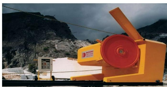
**Slika 3-15:** Dijamantna žična pila Series 1000 (Promidžbeni materijal tvrtke Dazzini Machhine, 2010.)
