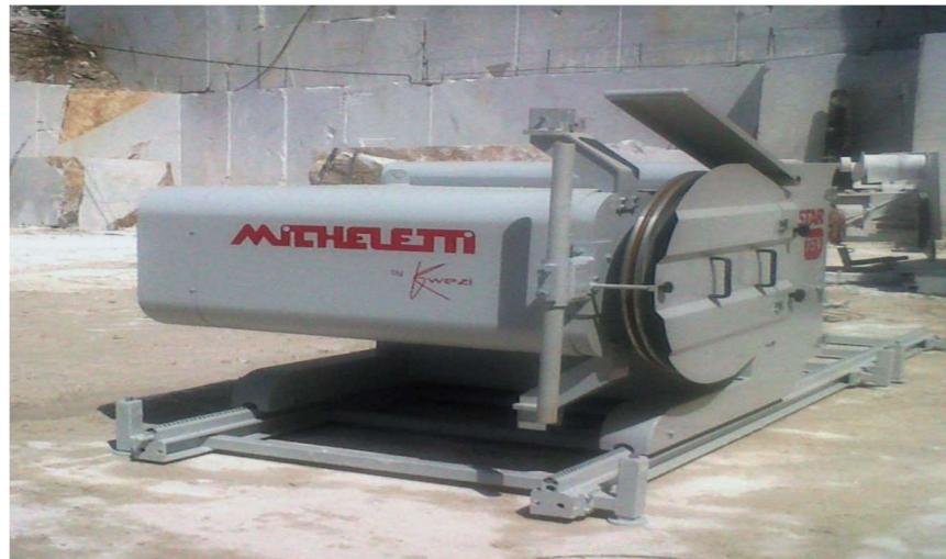
**Slika 3-11:** Dijamantna žična pila TELESTAR PLUS (Promidžbeni materijal tvrtke Micheletti, 2015.)
