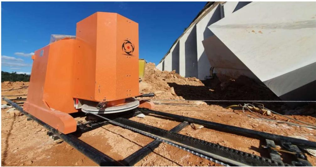
**Slika 3-18:** Dijamantna žična pila DWS (Promidžbeni materijal tvrtke Huada Superabsive Tool Technology, 2017.)
