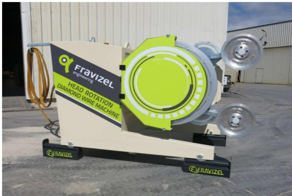
Slika 3-16: Dijamantna žična pila LYNX (Promidžbeni materijal tvrtke Fravizel, 2017.)
