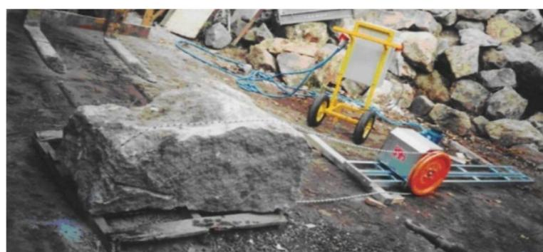
**Slika 3-13:** Dijamantna žična pila Series 300 (Promidžbeni materijal tvrtke Dazzini Machhine, 2010.)
