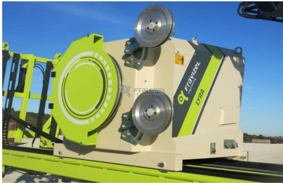
Slika 3-17: Dijamantna žična pila LYRA (Promidžbeni materijal tvrtke Fravizel, 2017.)
