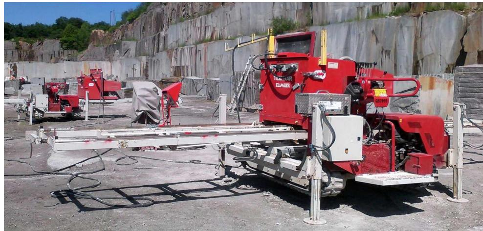
**Slika 3-12:** Dijamantna žična pila TELESTAR CLIMBER (Promidžbeni materijal tvrtke Micheletti, 2015.)
