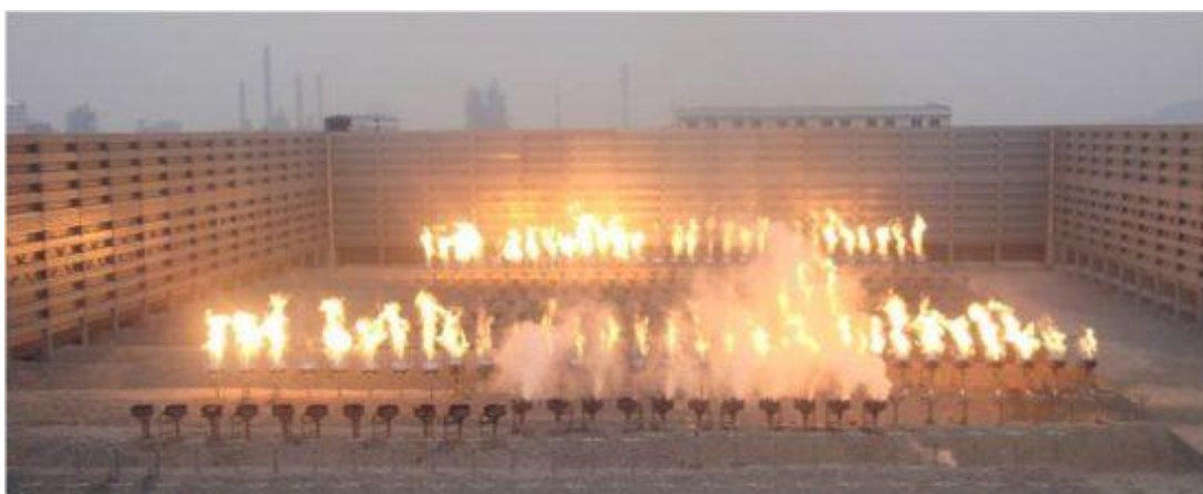
Slika 4-3. Vodoravna baklja s ogradom (Made-in-China, 2022)
