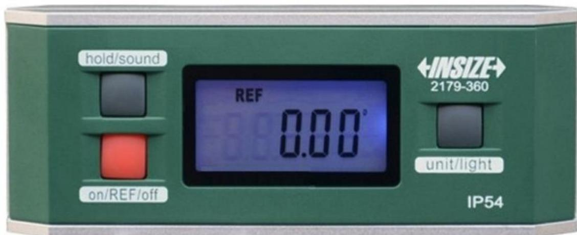
Slika 3-3 – Digitalni mjerač nagiba korišten u ispitivanjima ([insizeus.com](http://insizeus.com))
