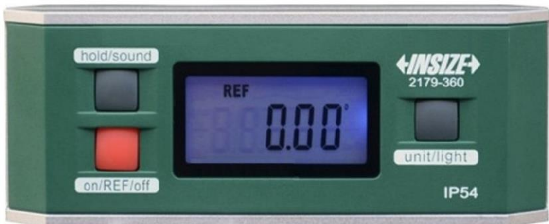
Slika 3-3 – Digitalni mjerač nagiba korišten u ispitivanjima ( insizeus.com )
