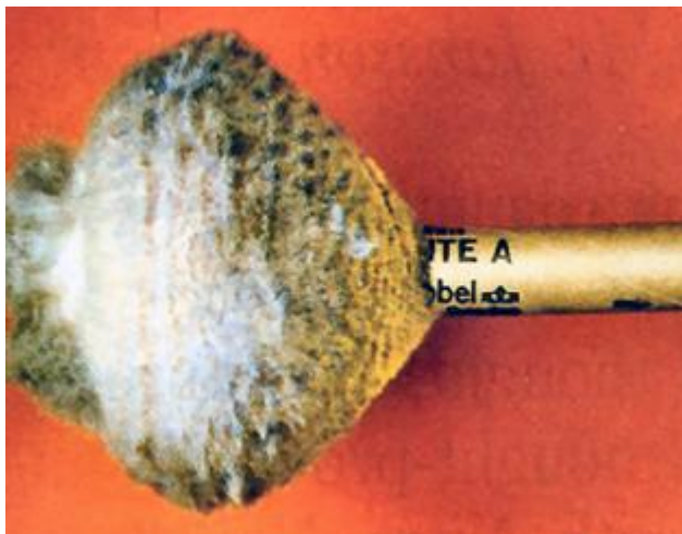
Slika 3-1. Patrona eksploziva pri detonaciji (Škrlec, 2015)
