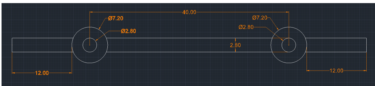
Slika 5-5. Dimenzije plastične spojnice, tlocrt
