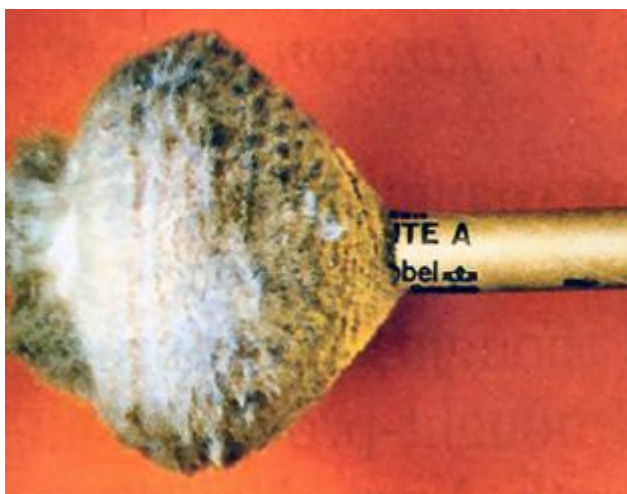
Slika 3-1. Patrona eksploziva pri detonaciji (Škrlec, 2015)
