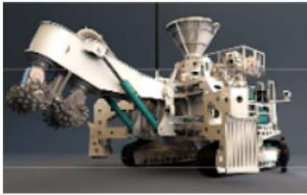
Slika 4-4. Pomoćni stroj za sukcesivni iskop s rotirajućom reznom glavom (Wang, 2013)
