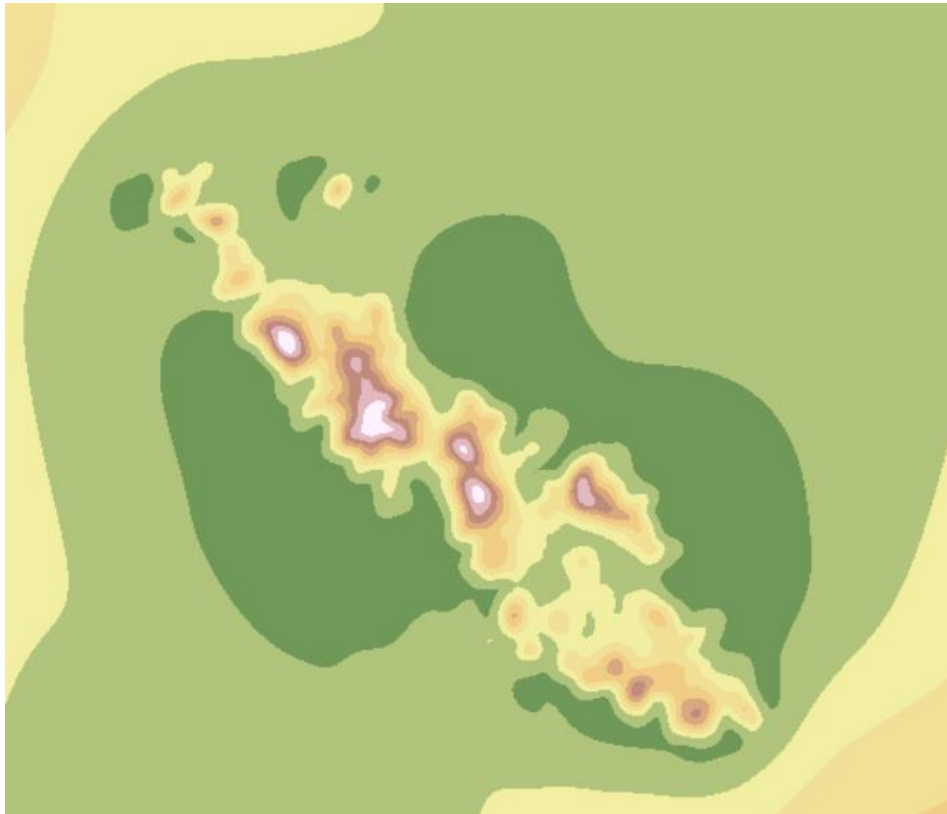
Slika 4-13. DMR otoka Murtera metodom Topo to Raster
