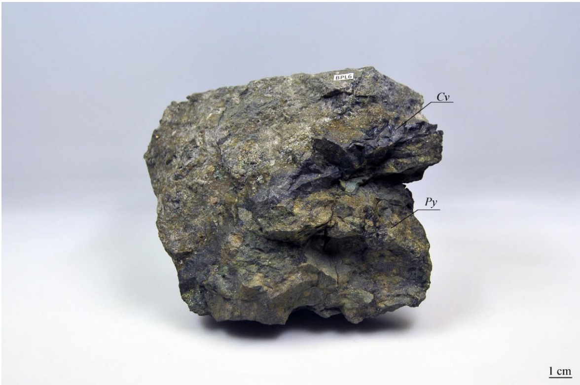
Slika 5-3 e: Cu-porfirna ruda (BPL6)
