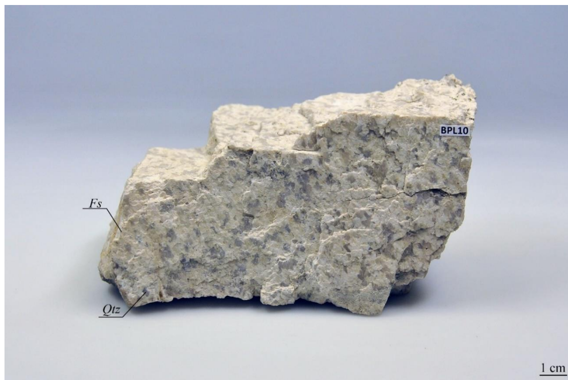
Slika 5-3 i: Alteracije u Cu-porfirnom ležištu (BPL10)
