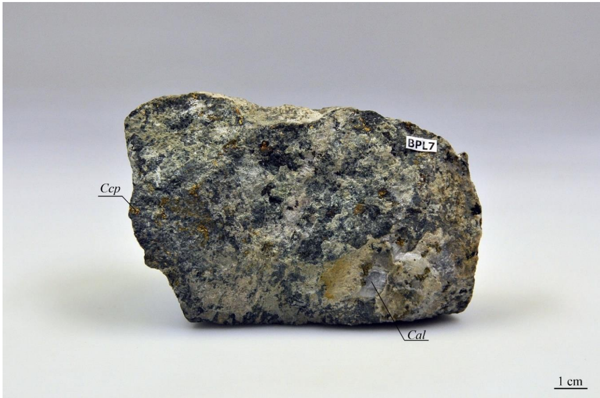
Slika 5-3 f: Cu-porfirno ležište, primarna diseminirana ruda (BPL7)
