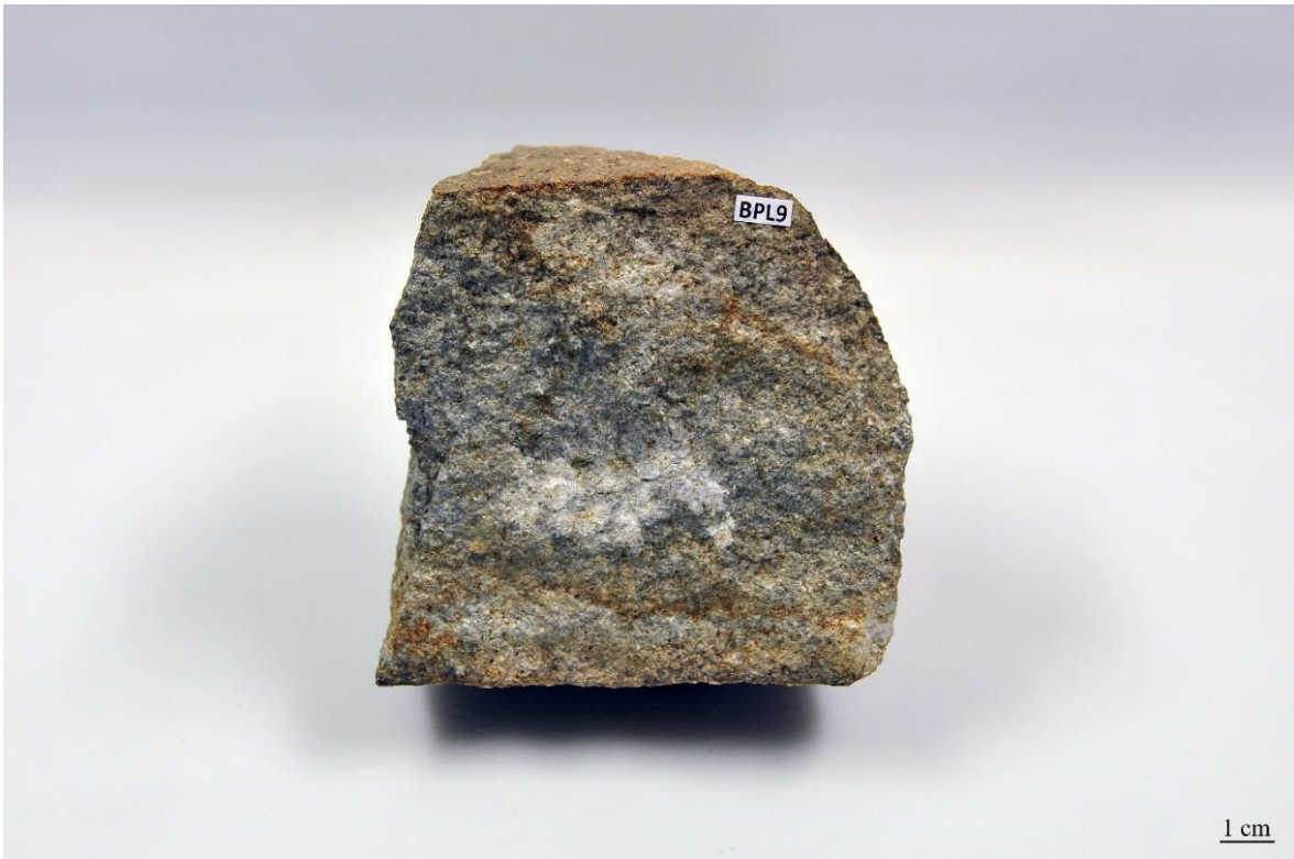
Slika 5-3 h: Cu-porfirno ležište, primarna diseminirana ruda (BPL9)
