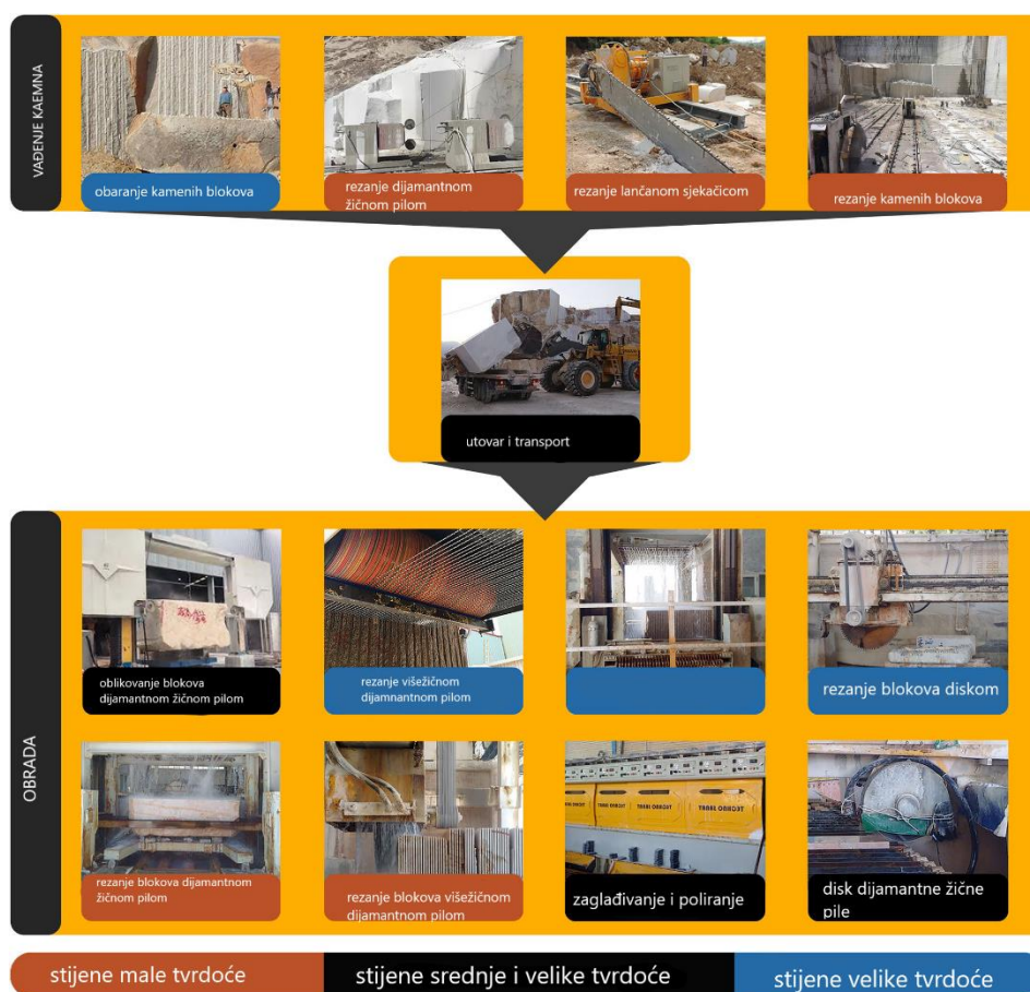
Slika 2-3. Proces eksploatacije i obrade kamena različite tvrdoće (Jalalian i sur., 2021)
