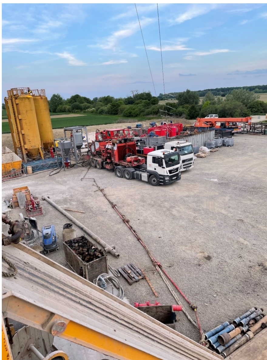
Slika 2-2. Oprema za izvođenje cementacije na kopnu
