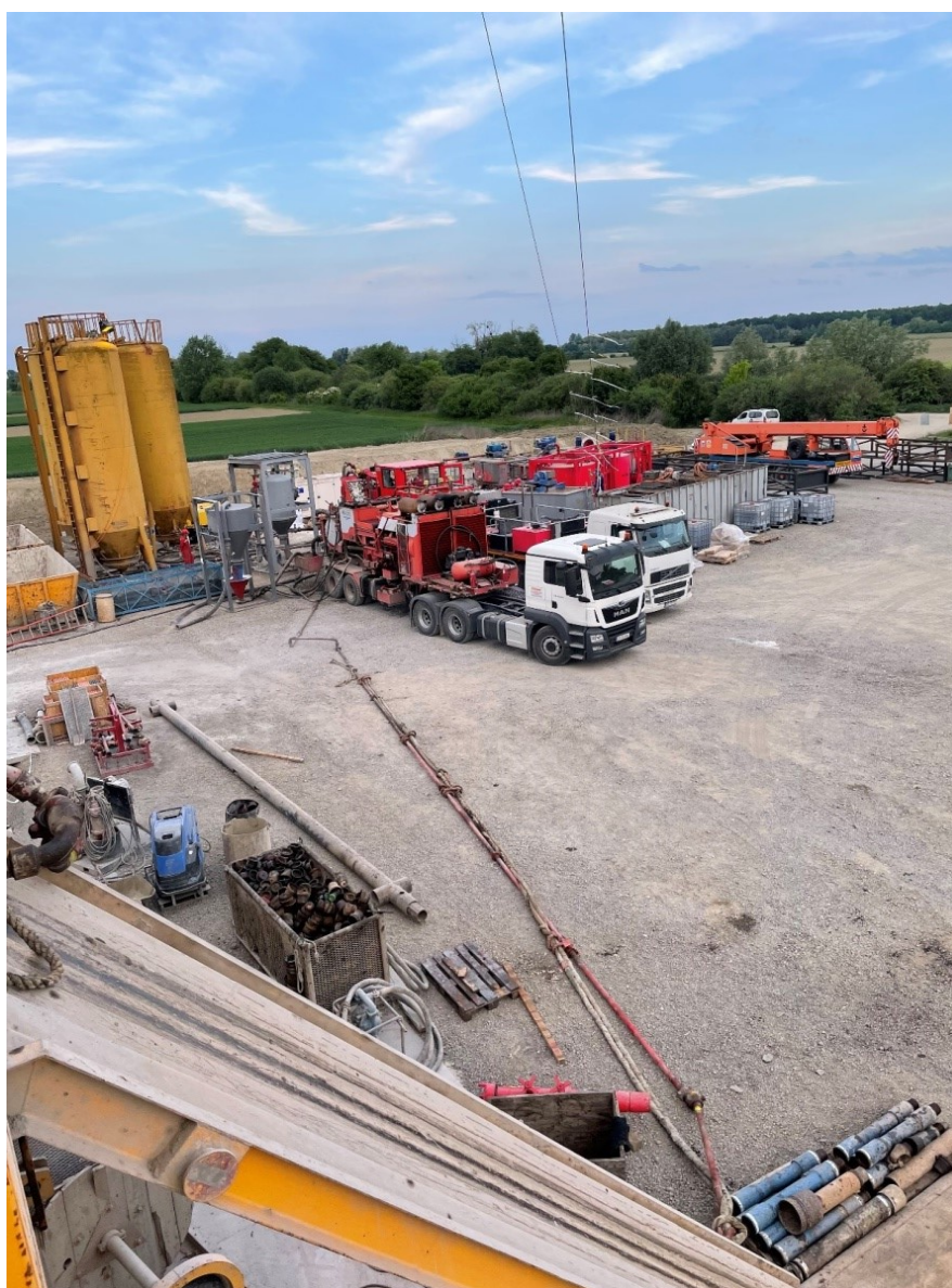
Slika 2-2. Oprema za izvođenje cementacije na kopnu
