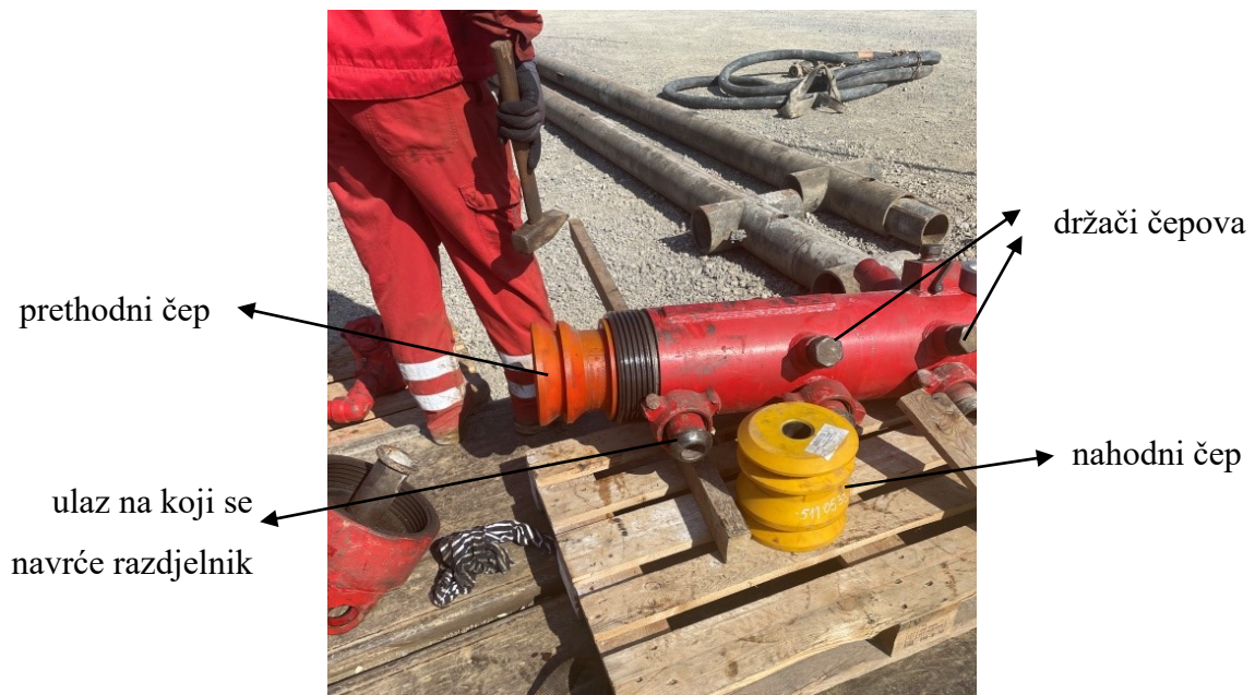
Slika 2-4. Postavljanje cementnih čepova u glavu za cementaciju
