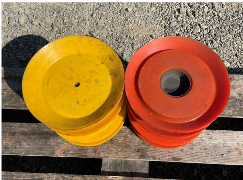
Slika 3-4. Prehodni i nahodni čep
