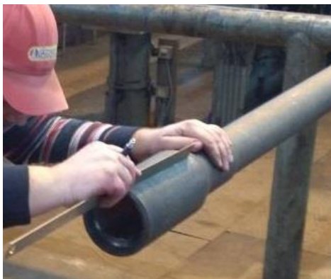
Slika 4-6. Provjera napuhnutosti i bubrenja spojnice bušaće šipke (CROSCO, 2019)
