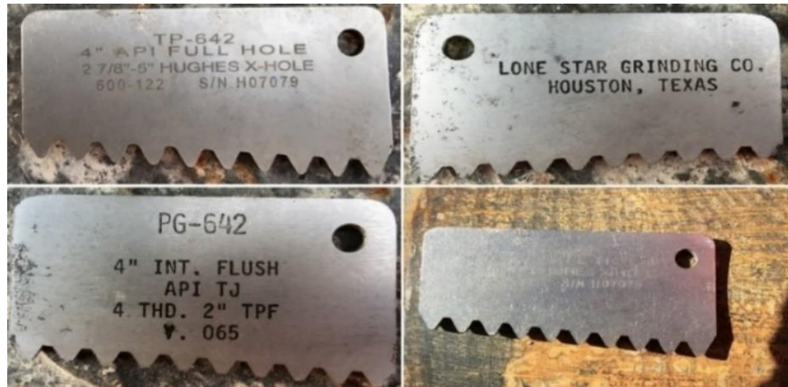
Slika 4-2. Kalibri za navoje korišteni kod vizualnog pregleda spojnica bušačkih šipki (CROSCO, 2019)
