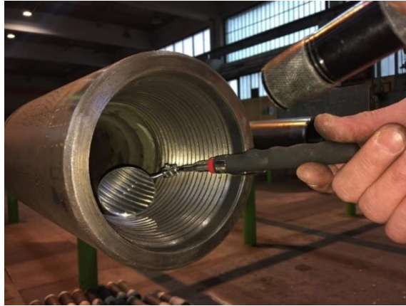
Slika 4-4. Traženje udubljenja vizualnom metodom (CROSCO, 2019)
