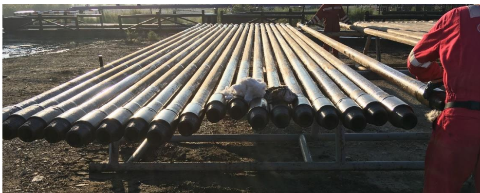
Slika 3-1. Pravilno poredane bušaće šipke s dovoljnim razmakom između njih da ih se može okretati za puni krug tijekom pregleda (CROSCO, 2019)
