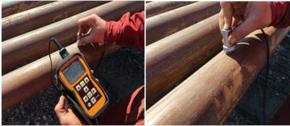
Slika 3-9. Postupak mjerenja debljine stijenke ultrazvučnim mjeračem (Crosco, 2008)
