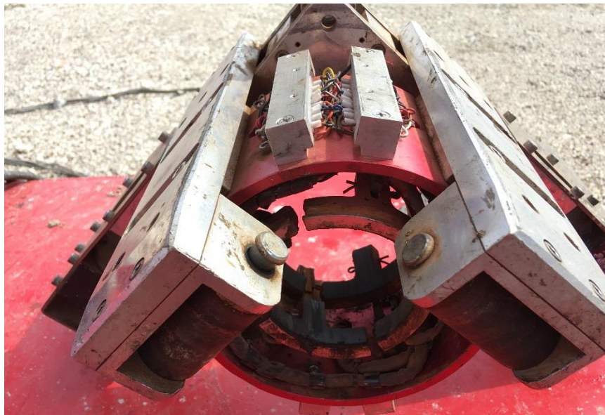
Slika 3-11. Ispitna glava s defektoskopskim papučama (Crosco, 2008)
