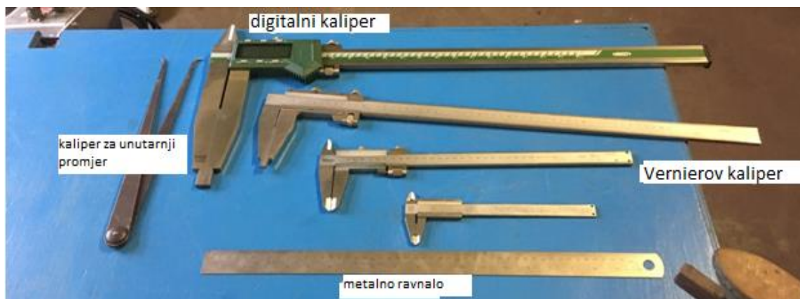
Slika 4-1. Oprema za dimenzionalni pregled tubinga i spojnice (Crosco, 2008)
