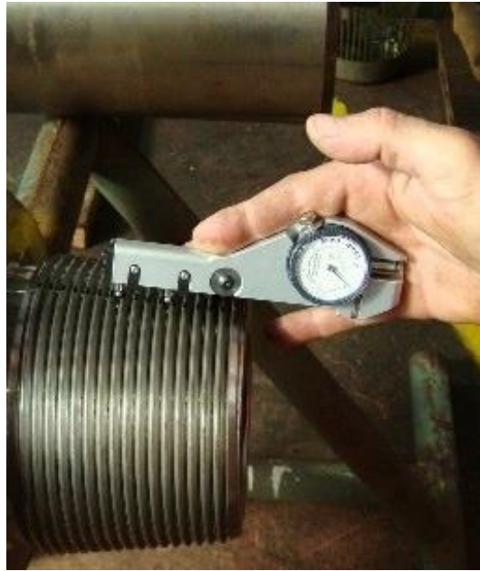
Slika 4-4. Provjera produljenja muškog navoja mjerilom uspona (Crosco, 2008)
