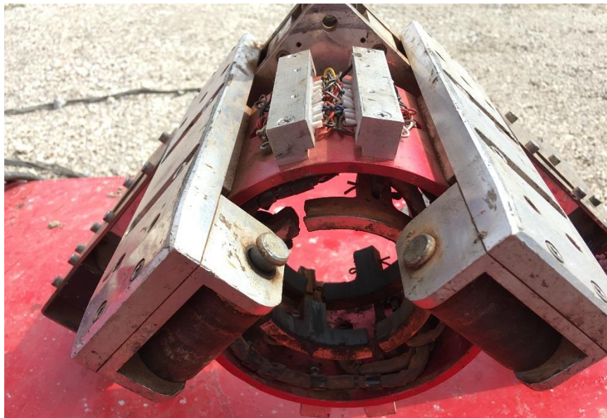
Slika 3-11. Ispitna glava s defektoskopskim papučama (Crosco, 2008)
