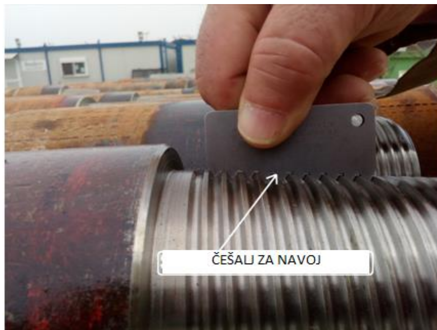
Slika 4-6. Provjera istrošenosti navoja češljem za navoj (Crosco, 2008)
