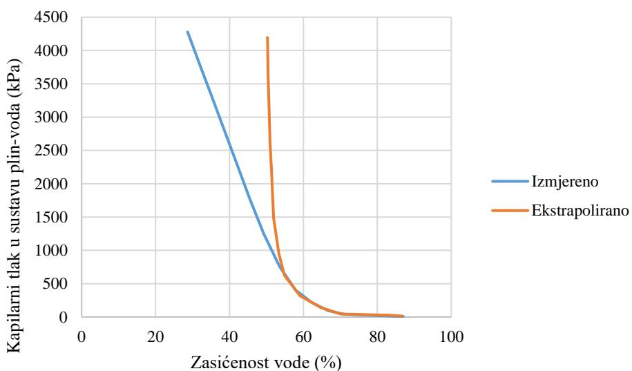
Slika 5-2. Usporedba mjerene i ekstrapolirane zasićenosti vode
