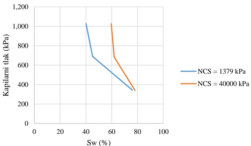
**Slika 3-1.** Utjecaj graničnog naprezanja na primarni drenažni kapilarni tlak
