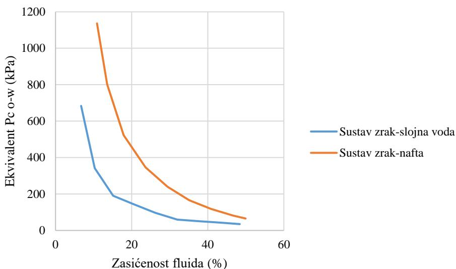
**Slika 4-2.** Kapilarni tlak pri sustavu zrak-nafta te pri sustavu zrak-slojna voda indikativan više za naftomocive karakteristike
