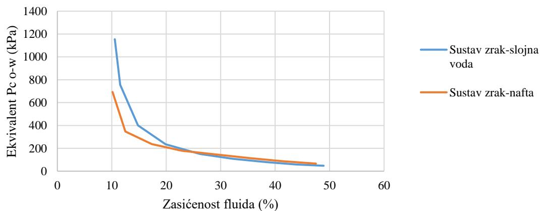
**Slika 4-1.** Kapilarni tlak pri sustavu zrak-nafta te pri sustavu zrak-slojna voda indikativan više za vodom očive karakteristike
