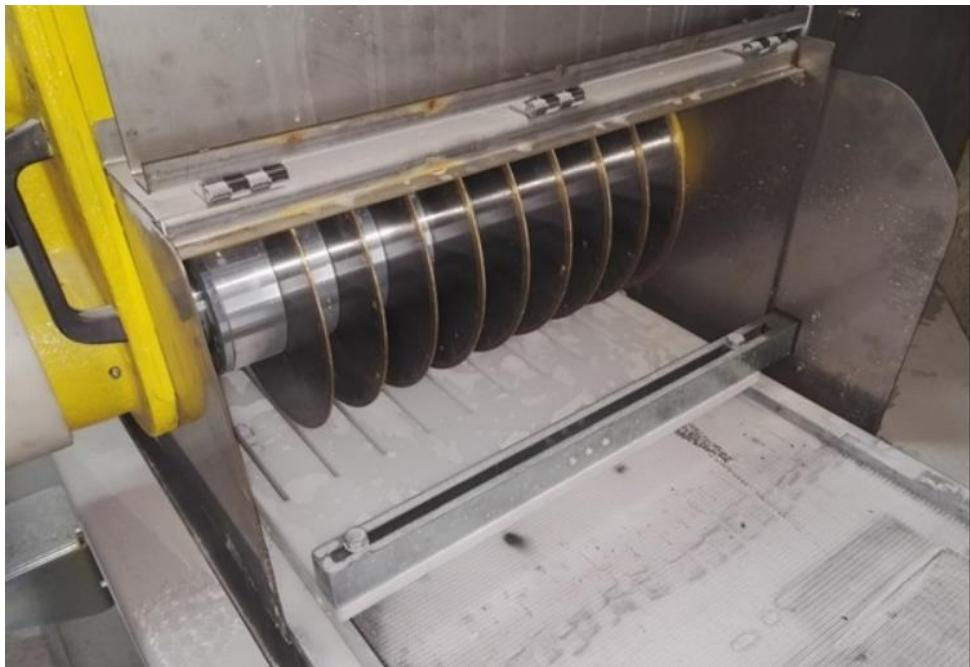
Slika 4-3. Jednoetažni stroj s više diskova (Stonecontact, 2022)
