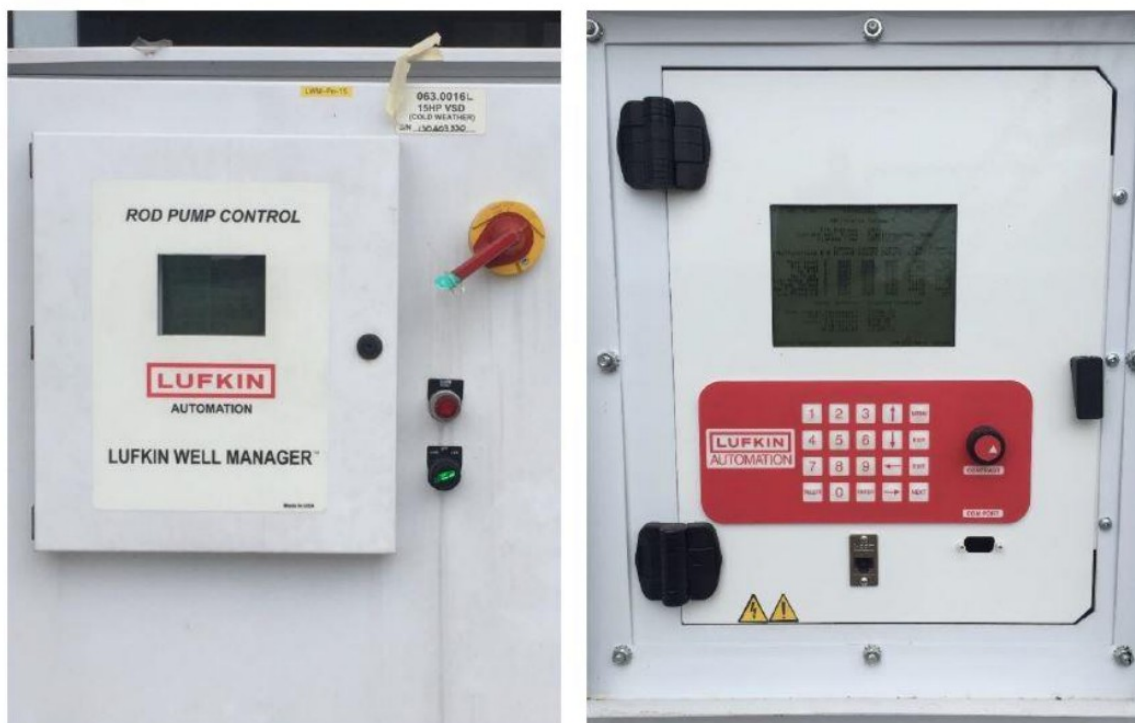
Slika 3-1. RPC - upravljački uređaj (INA d.d., 2015)
