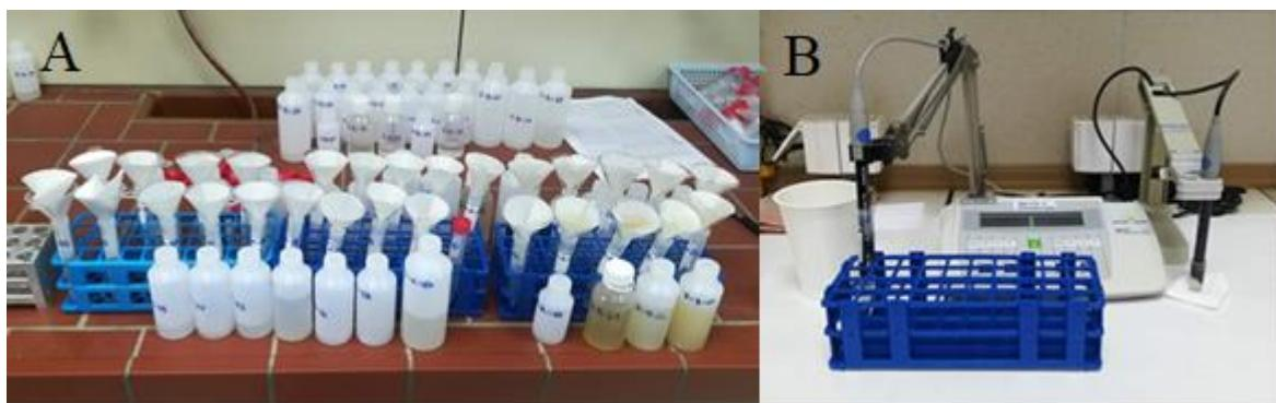
**Slika 3-2.** A) Priprema uzoraka za mjerjenje pH i električne vodljivosti, B) mjerjenje pH tla i električne vodljivosti pH-metrom i konduktometrom (EC-metar) Mettler Toledo MPC227 u suspenziji u vodi.
