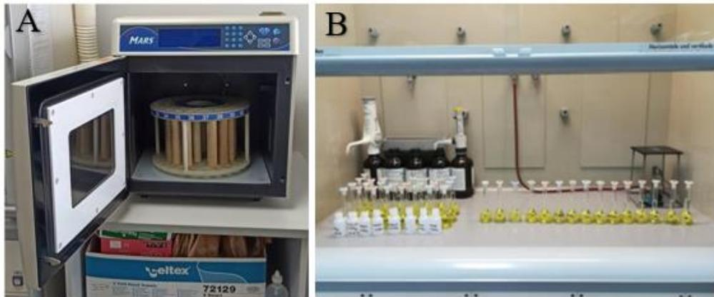
**Slika 3-5.** A) MARSXpress mikrovalni sustav (CEM) za razlaganje uzoraka tla u zlatotopci, B) Priprema ekstrakta tla za mjerjenje ukupnih koncentracija metala.
