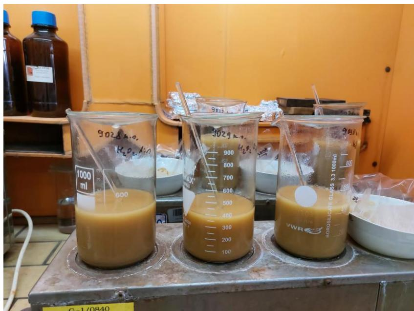
**Slika 3-7.** Uklanjanje organske materije primjenom 15 % vodikovog peroksid-a.
