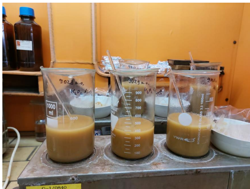
Slika 3-7. Uklanjanje organske materije primjenom 15 % vodikovog peroksida.
