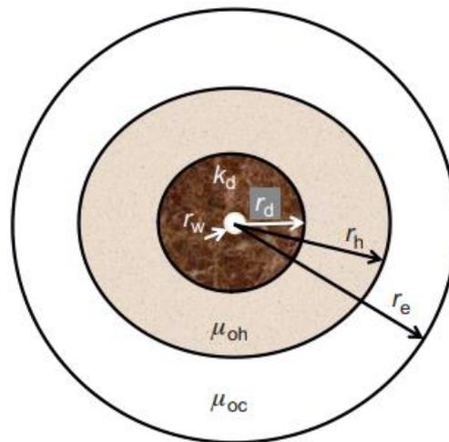
**Slika 2-2.** Shematski prikaz radijalnog protoka u bušotini nakon utiskivanja vodene pare (Sheng, 2013)
