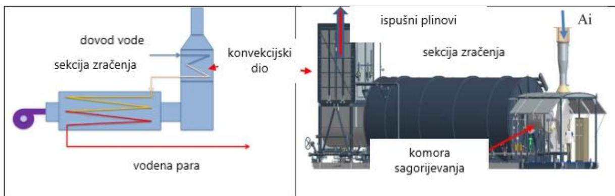
**Slika 3-7.** Proces generiranja vodene pare (Al-Ajmi et al., 2018)
