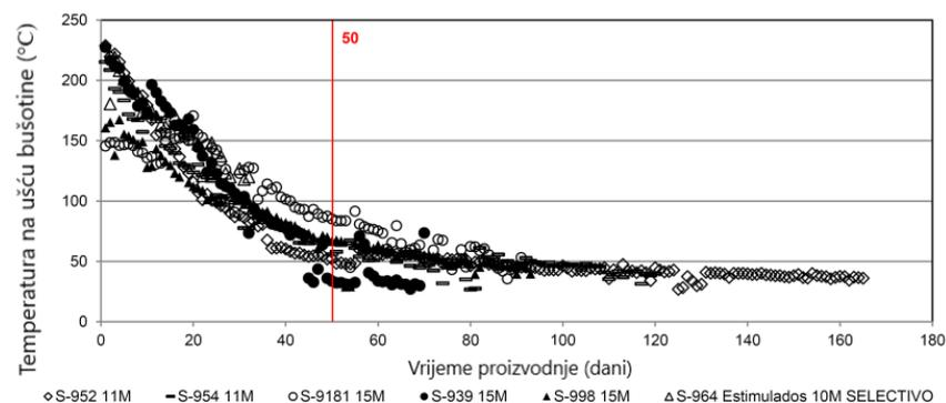
Temperatura na ušću bušotine kod ležišta debljine 10 m do 15 m
