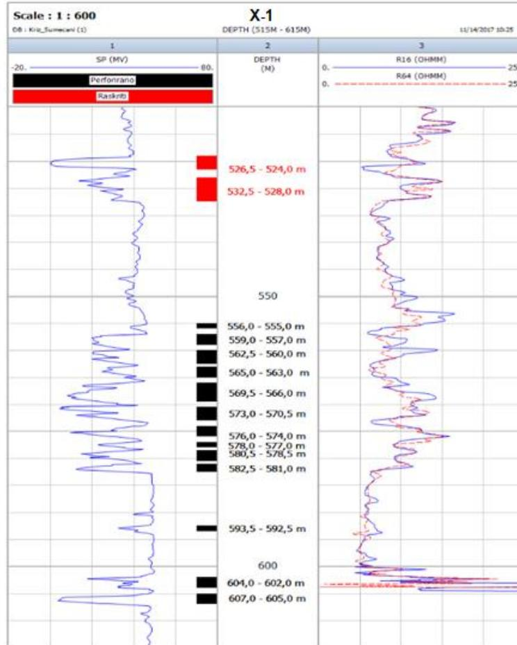
**Slika 5-3.** Dijagram karotažnih mjerenja i otvorenih intervala na bušotini X-1 (INA d.d., 2017)
