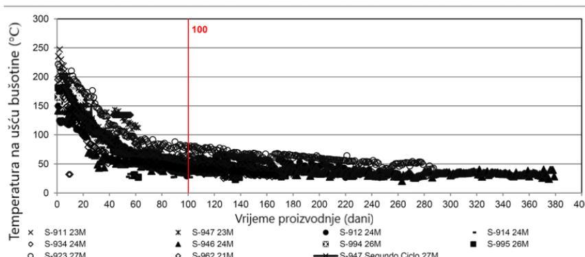
Temperatura na ušću bušotine kod ležišta debljine 21 m do 30 m
