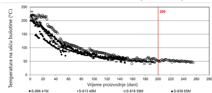
Temperatura na ušću bušotine kod ležišta debljine 41 m do 80 m
