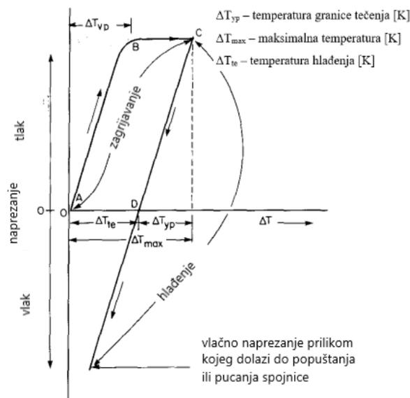
**Slika 3-9.** Napreznja zaštitnih cijevi uslijed promjene temperature (Willhite i Dietrich, 1967)
