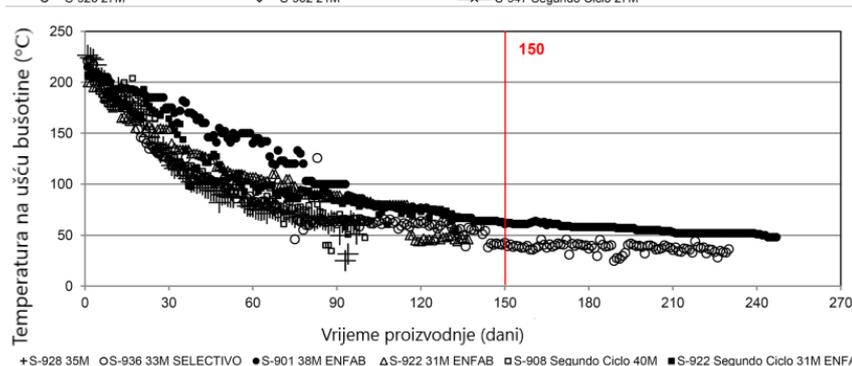
Temperatura na ušću bušotine kod ležišta debljine 31 m do 40 m
