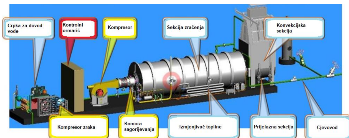
Slika 3-8. Dijelovi generatora mokre vodene pare ( www.enhanced-oil-recovery.com , 2022)
