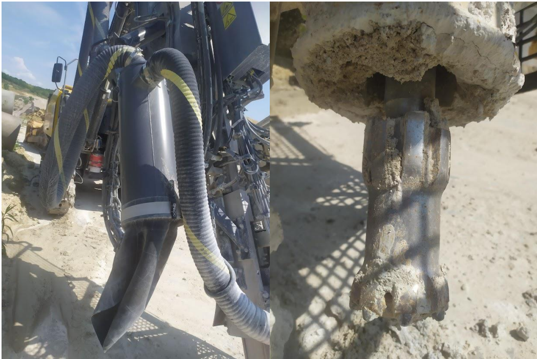
Slika 4-3 Filter i bušaća kruna
