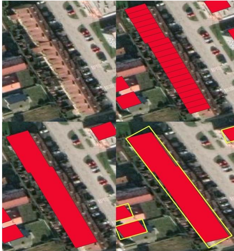
Slika 2-9. Primjer OMBB-a na primjeru kompleksa zgrade
