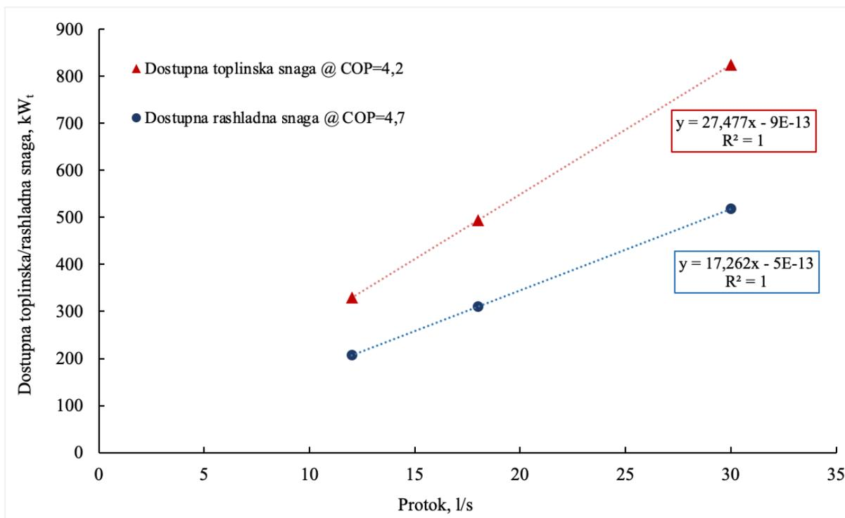
**Slika 7-6.** Prikaz odnosa dostupne toplinske/rashladne energije i protoka uz pretpostavljene tipične vrijednosti  $COP_H=4,2$  i  $COP_C=4,7$ .
