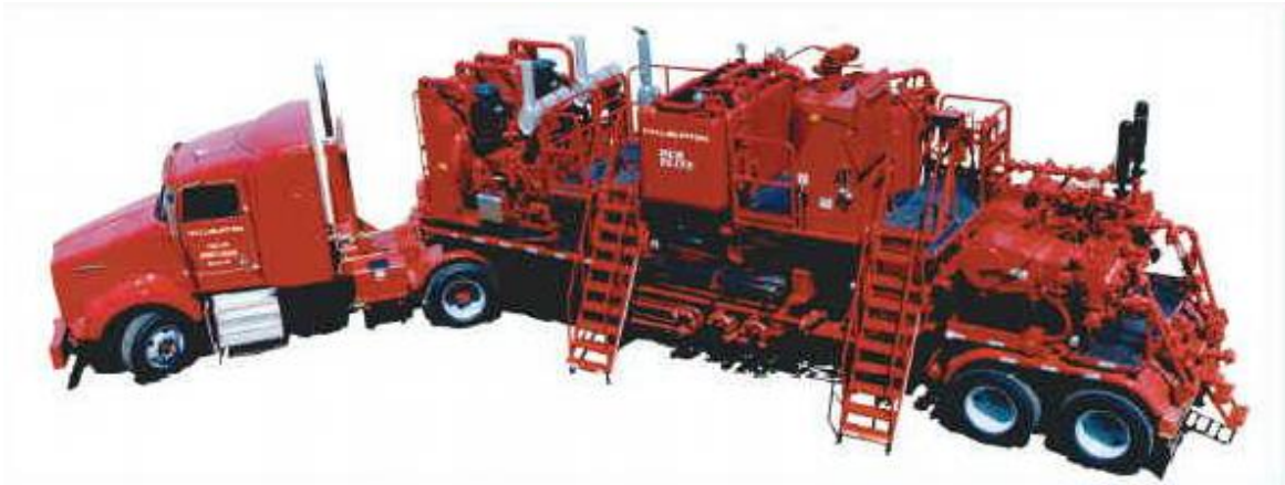
Slika 4-19. Cementacijski agregat (Gaurina-Međimurec, 2020)
