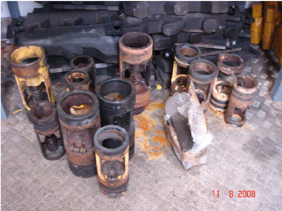
Slika 4-13. Protupovratni ventili (Putra, 2008)
