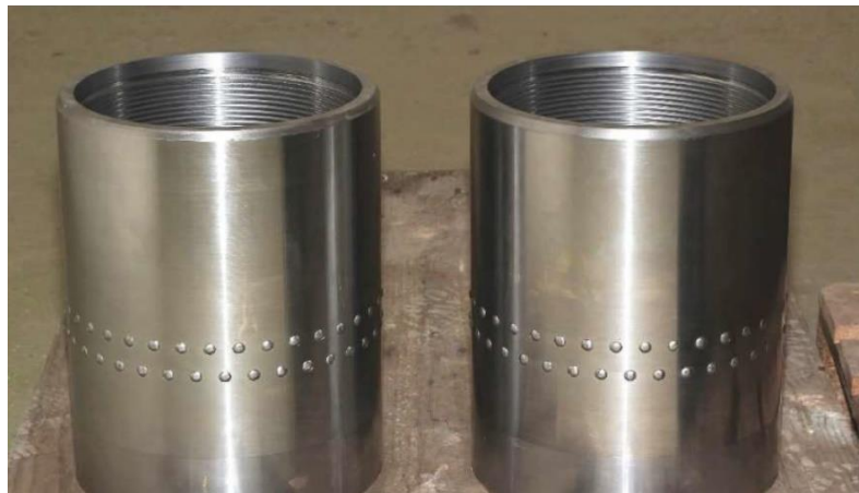
Slika 4-18. Prototipovi fleksibilnih spojnica (Thorbjornsson et al., 2017)
