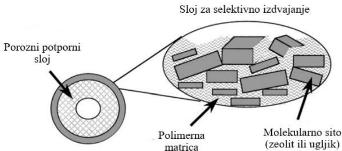
**Slika 5-7.** Shema mješovite matrične membrane (Shekhawat et al., 2003)
