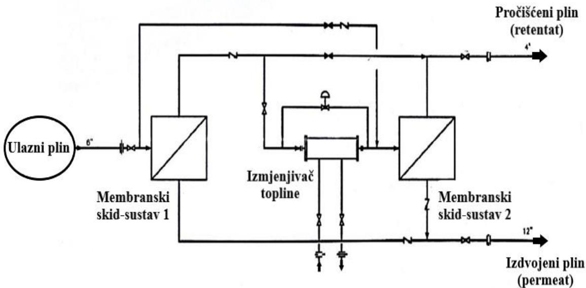
**Slika 8-2.** Membranska sekcija za izdvajanje kiselih plinova (SCAN, 2022)
