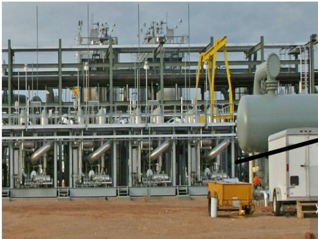
Slika 6-3. Membranske skid-jedinice na Kinder Morganovom SACROC postrojenju za izdvajanje kiselih plinova (Gas Liquids Engineering, 2021)
