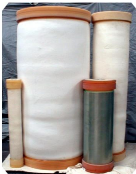
Slika 4-3. Membranski elementi od šupljih vlakana (Morisato, 2017)
