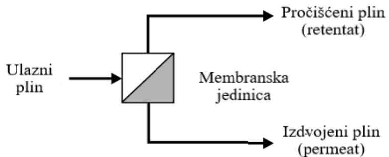
**Slika 4-11.** Jednostupanjski membranski sustav (Sridhar et al., 2007)
