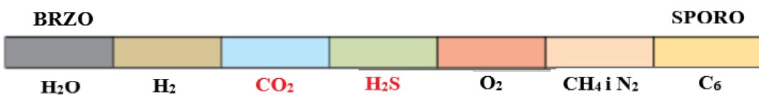
**Slika 5-1.** Brzina strujanja pojedenih komponenti plina u staklenoj membrani (Gas processing & LNG, 2022)
