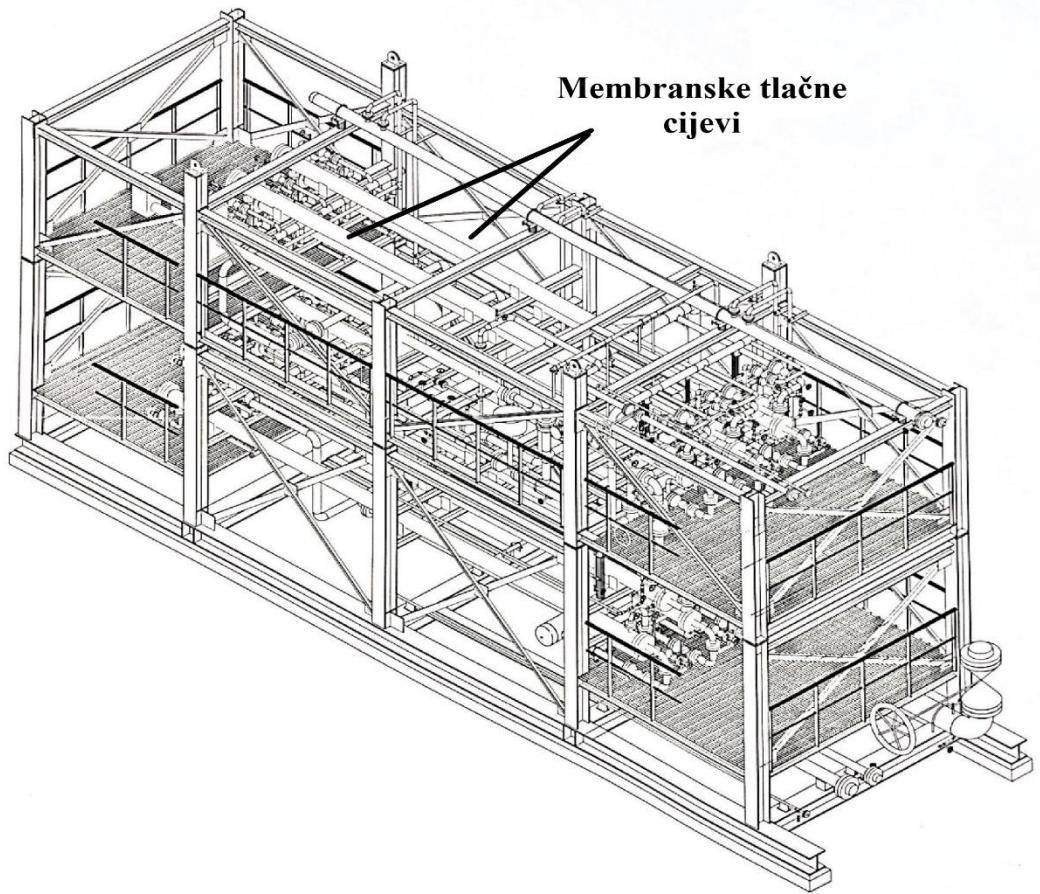
**Slika 8-3.** Separex membranski skid (SCAN, 2022)
