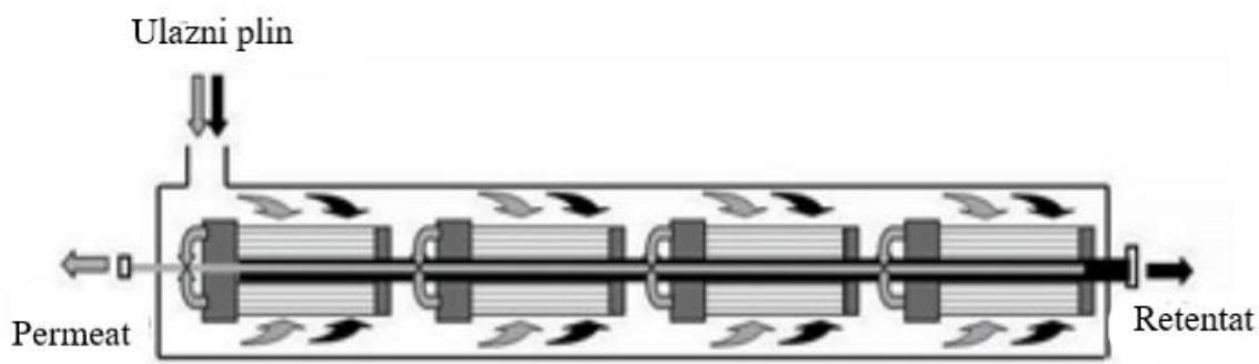
**Slika 4-5.** Membranska tlačna cijev (kućište) s četiri membranska elementa od šupljih vlakana (Gas processing & LNG, 2022)
