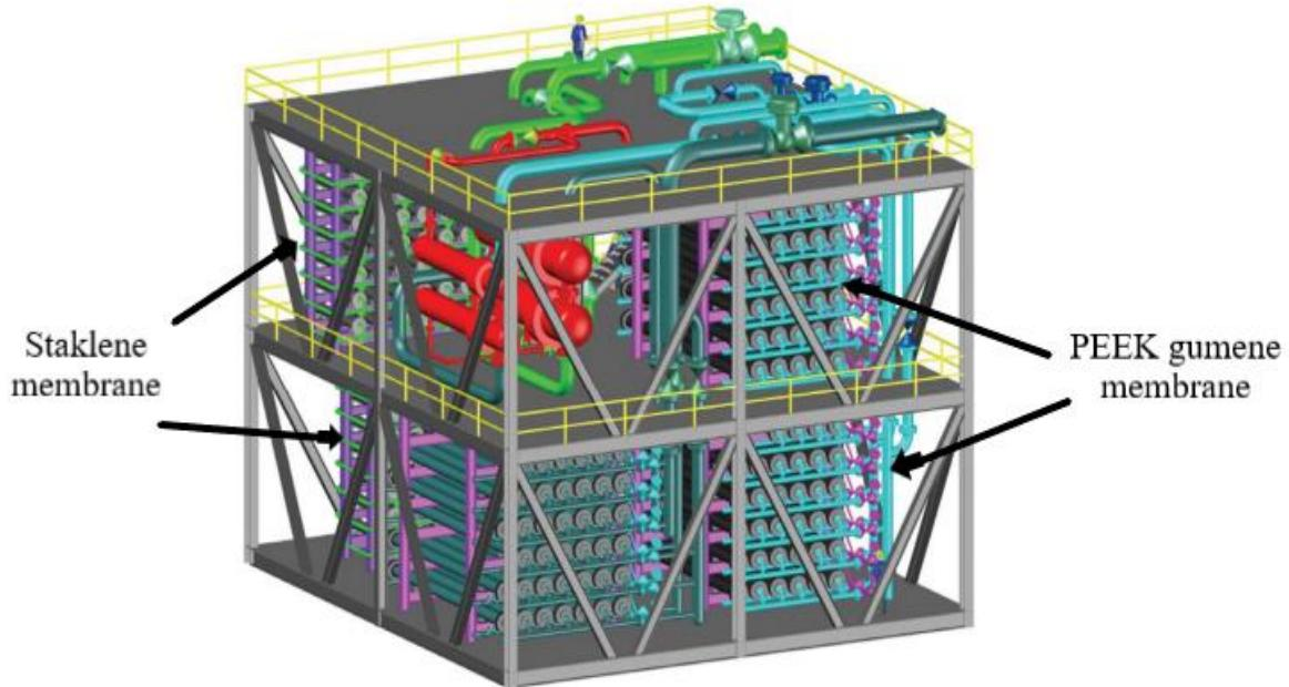
**Slika 5-5.** Membranski skid-sustav s PEEK membranama za predobradu plina (Air Liquide, 2016)
