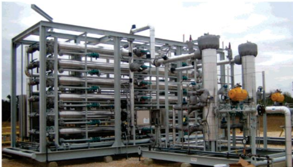
Slika 4-6. Membranski skid s horizontalnim tlačnim cijevima i membranskim elementima (Baker i Lokhandwala, 2008)
