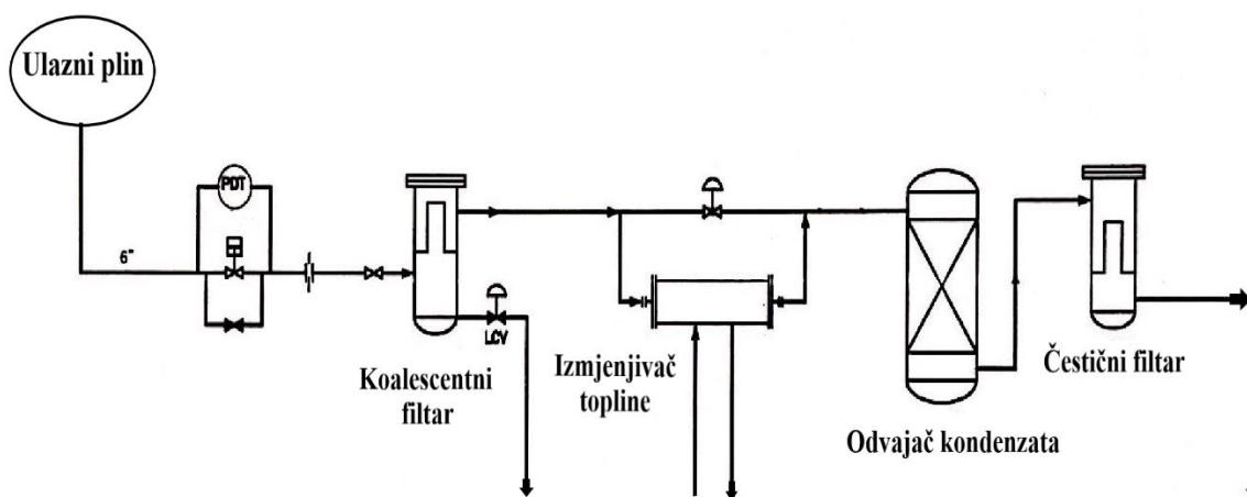
Slika 8-1. Shema sustava za predobradu ulaznog plina (SCAN, 2022)
