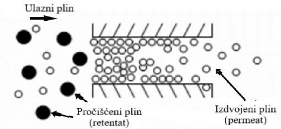
**Slika 3-5.** Kapilarna kondenzacija (Shekhawat et al., 2003)
