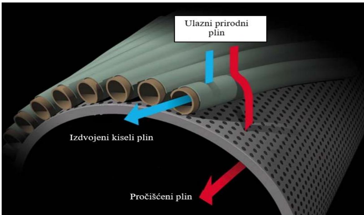
**Slika 4-9.** Presjek membrane od šupljih vlakana (Honeywell UOP, 2009)
