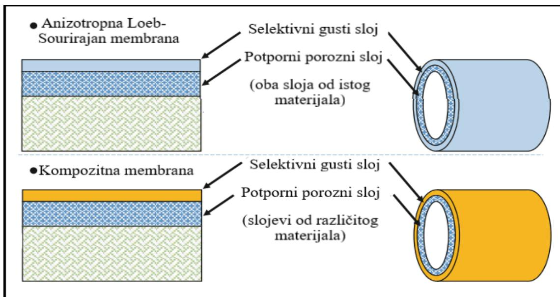
**Slika 4-10.** Anizotropna Loeb-Sourirajanova membrana i komositna membrana (Chen et al., 2021)
