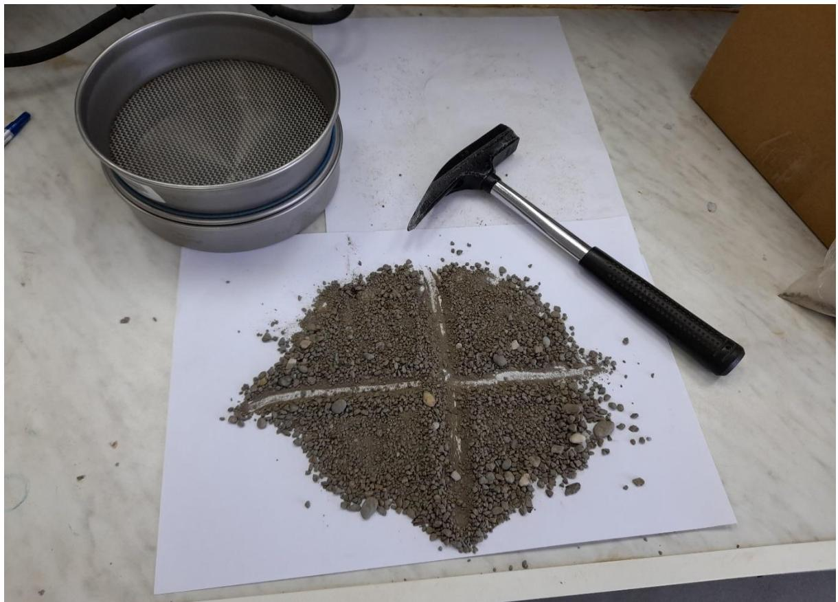
**Slika 4.2.** Četvrtanje, drobljenje i prosijavanje uzorka tla
