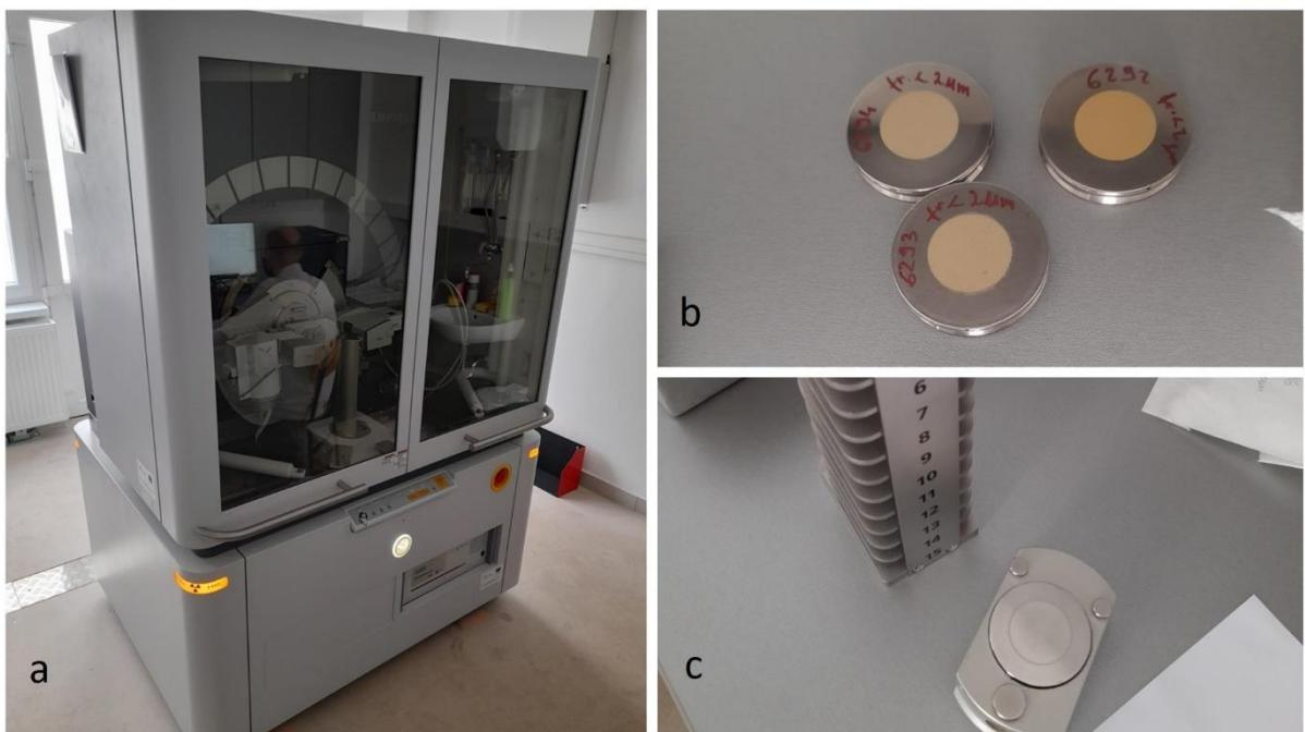
**Slika 4.5. a) RTG uređaj, b) nosači uzoraka, c) izmjenjivač uzoraka („sample changer“)**
