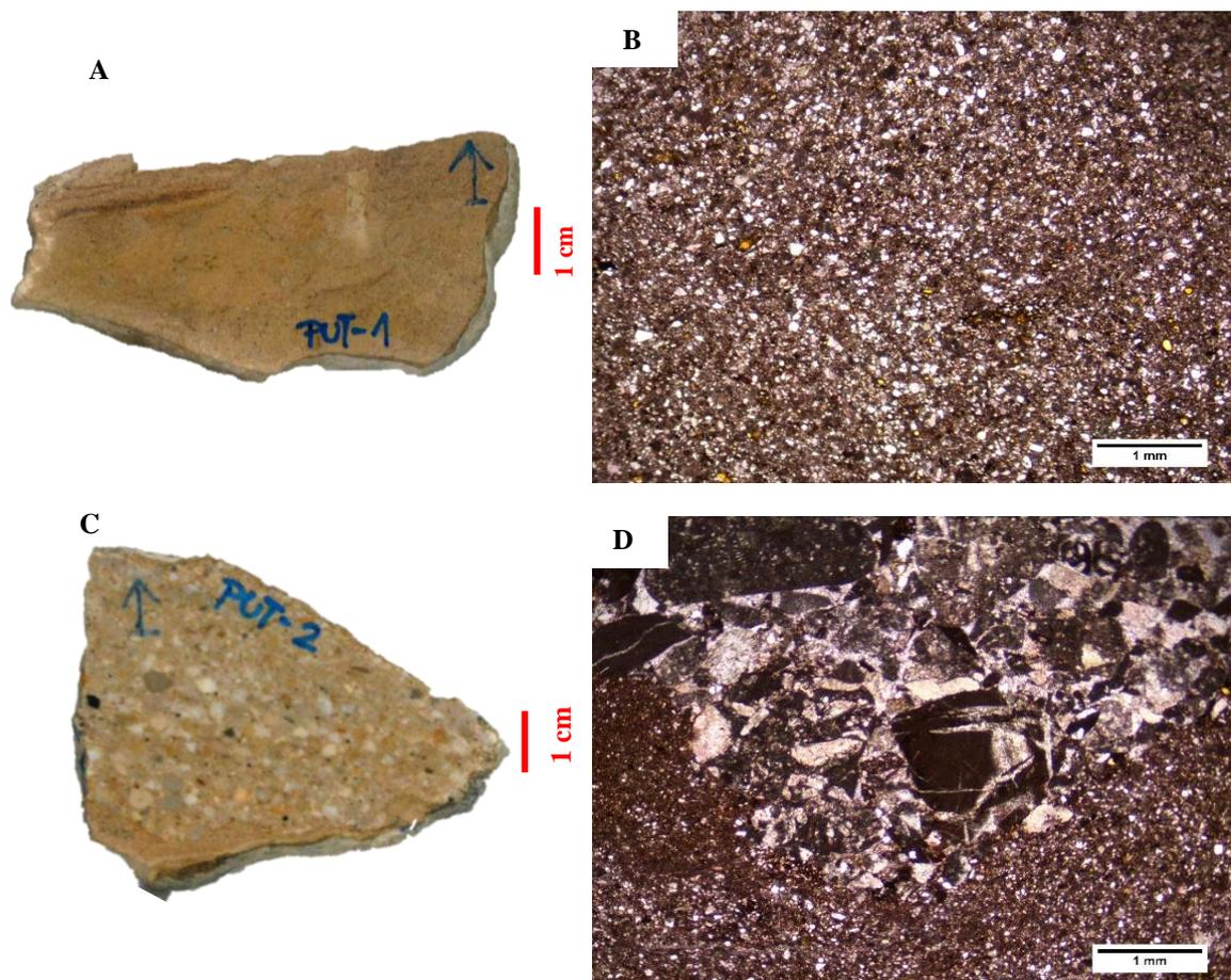
Slika 6.24. Ispolirani uzorci te mikrofotografije uzoraka uzetih iz stupa PUT. A. i B. PUT-1.;
