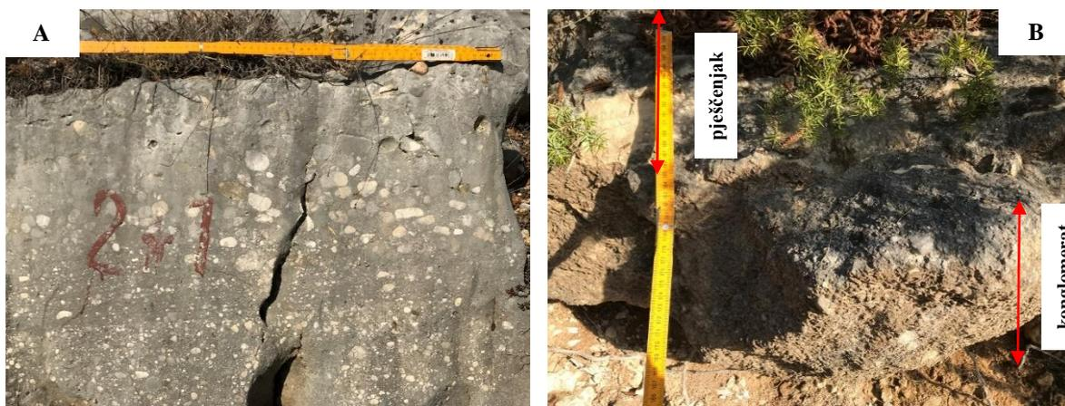
Slika 6.21. A- postupno smanjivanje zrna unutar konglomerata, od vrha prema dnu - obrnuta gradacija.;
