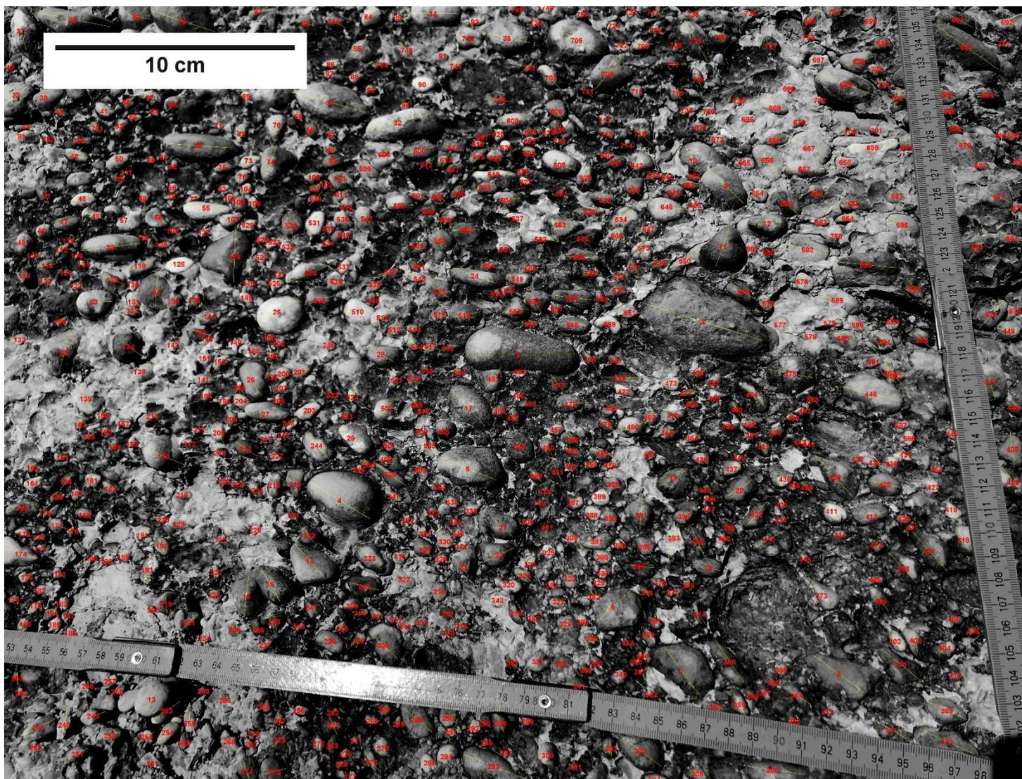
**Slika 6.19. Fotografija nakon obrade u računalnom programu *ImageJ*, crvenim brojevima označena su zrna koja su mjerena. Povezani brojevi zrna s točnim promjerima prikazani su u Tablici 6.1.**
