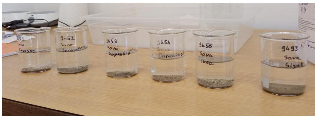
Slika 3–9. Natapanje uzoraka u destiliranoj vodi 24 sata prije mjerena s Mastersizerom 3000.
