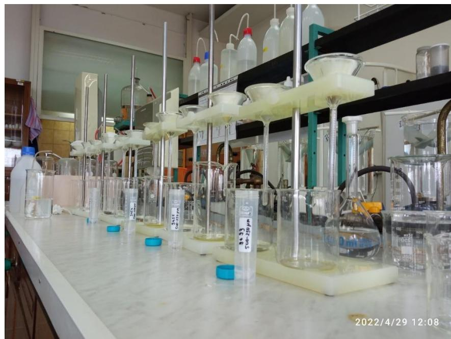
Slika 3–11. Aparatura za separaciju uzorka natrijevim volframatom.
