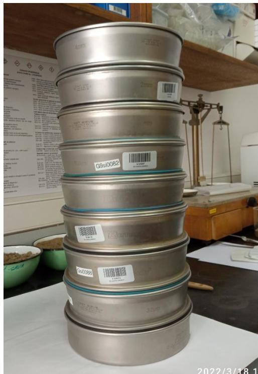
**Slika 3–7.** Set laboratorijskih sita s otvorom rupica od 4 mm (na vrhu) do 0,032 mm.
