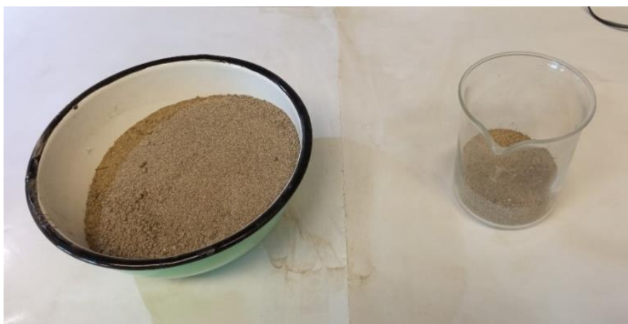
Slika 4–1. Uzorak 9453. Desno u laboratorijskoj čaši se nalazi količina uzorka koja se prosijavala kroz sita, lijevo u zdjelici je ostatak uzorka nakon četvrtanja.
