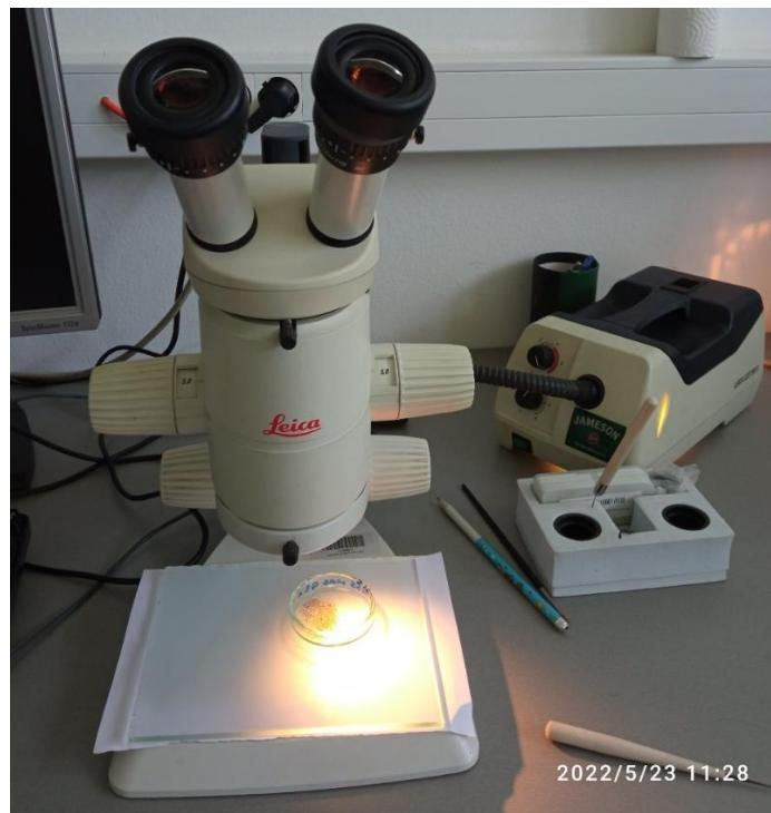
Slika 3–12. Binokularna stereoskopska lupa.
