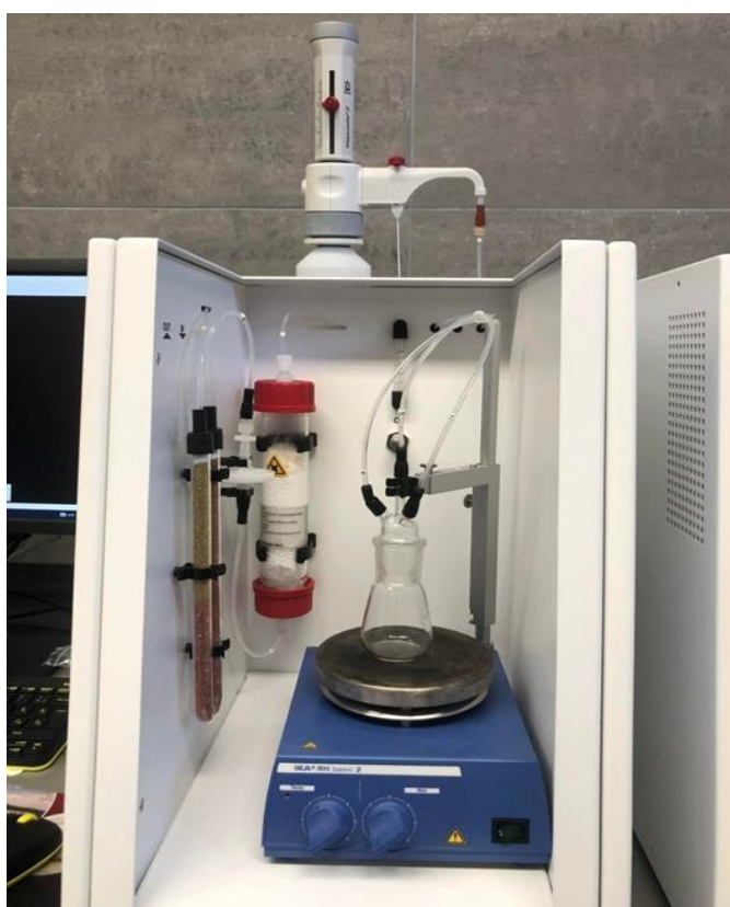
Slika 4.5. Uređaj za mjerenje TIC modula.
